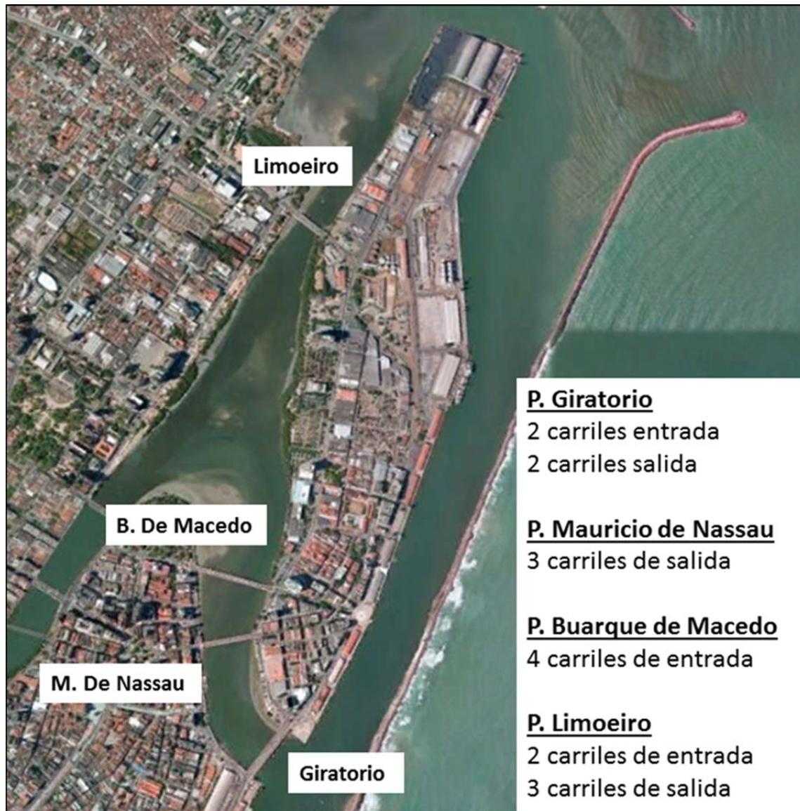
Figura 11. Identificación y características de los puentes de acceso al barrio de Recife
