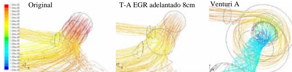
Figura 5.18. Líneas de corriente en el colector de admisión en el instante de mayor gasto a través de las válvulas de cilindro 4 bajo las condiciones de funcionamiento L para diversas configuraciones de EGR. Izquierda: sistema original. Central: sistema con entrada de EGR adelantada (t-A). Derecha: venturi F.
