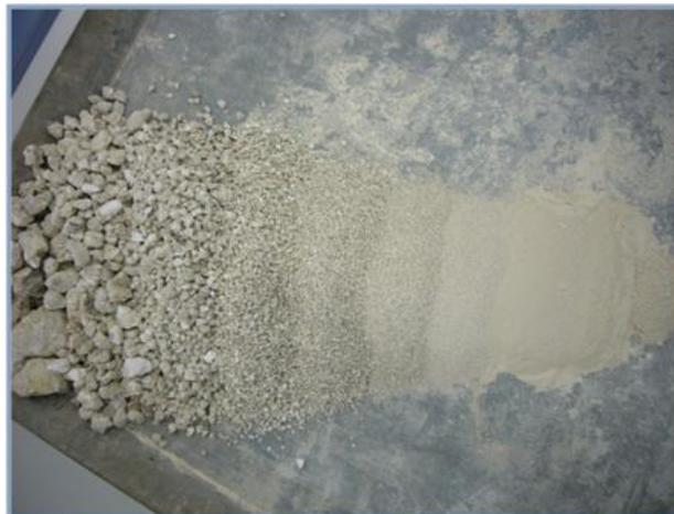
Fotografía 131 y 132. Muestra después de la separación tras el análisis granulométrico.
