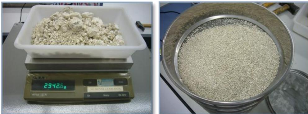
Fotografía 129 y 130. Pesada de la muestra en Balanza de precisión. Muestra de árido acumulado sobre uno de los tamices.
