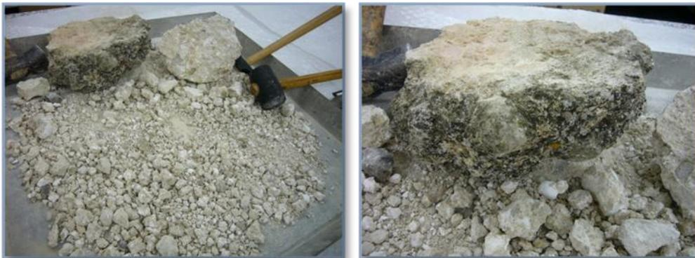
Fotografía 125 y 126. Proceso de separación de la muestra de tapia.
