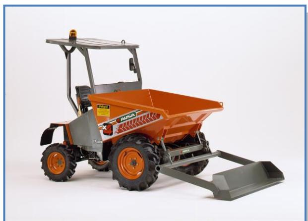
Fotografía 182 y 183. Ejemplos de maquinaria a utilizar para proceder al vaciado interior de rellenos.
