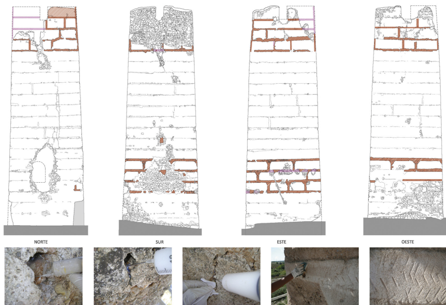
Fig. 4.194. Limpieza, consolidación y sellado de bandas decorativas. (Según Mileto y Vegas)
