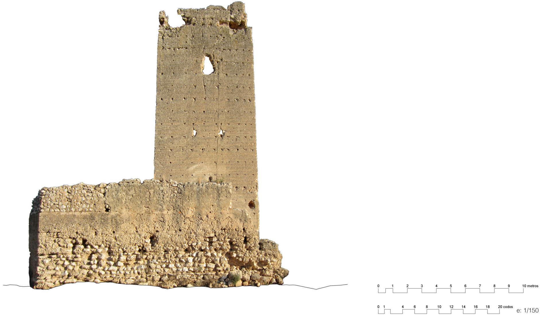
Fig. 10.13. Alzado Oeste. Levantamiento ortofotogramétrico. (Elaboración propia)
