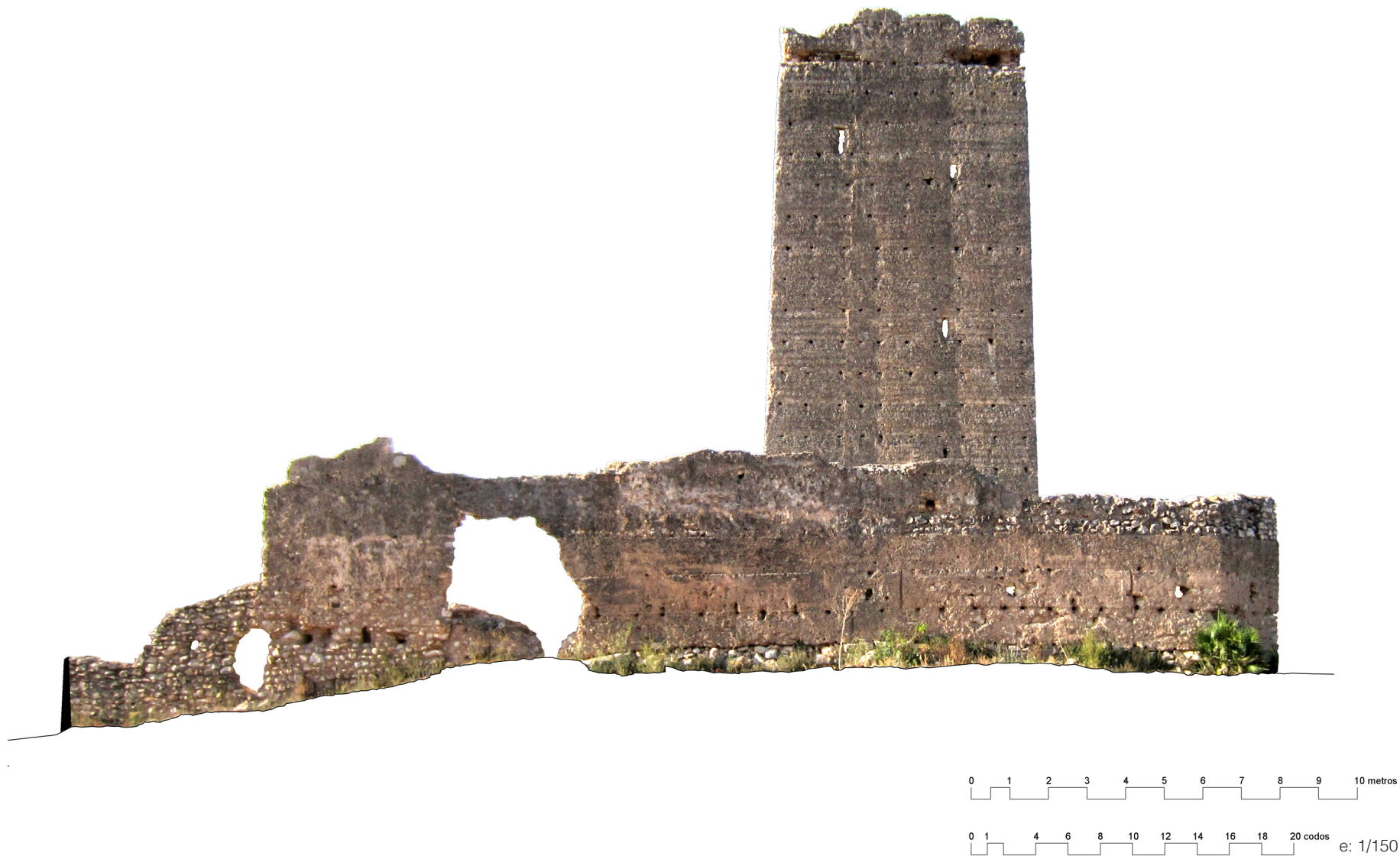
Fig. 10.15. Alzado Norte. Levantamiento ortofotogramétrico. (Elaboración propia)
