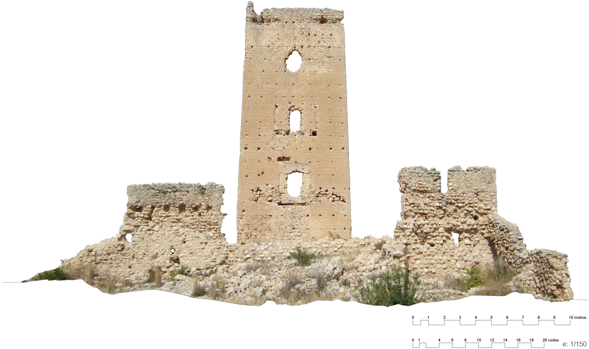
Fig. 10.9. Alzado Este. Levantamiento ortofotogramétrico. (Elaboración propia)
