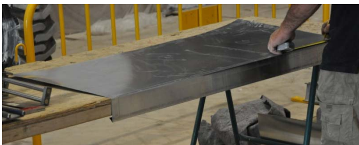
Grupo de imágenes 6.107 Realización del doblado de la pieza de zinc.
