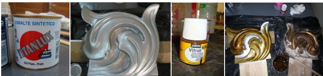
6.840, 6.841 Aplicación de esmalte sintético de plata. 6.842, 6.843 Tono oro.
