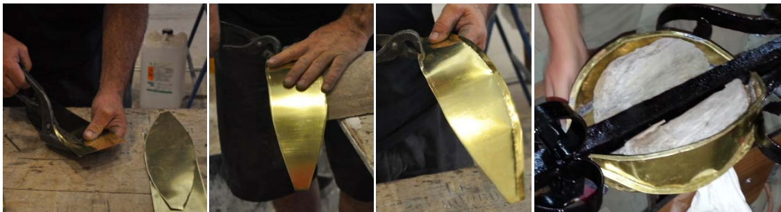
Grupo de imágenes 6.587 Proceso de ejecución de la bola de latón.
