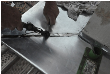
6.119 Realización cordón soldadura.
