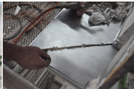
6.117, 6.118 Aplicación líquido para soldadura.
