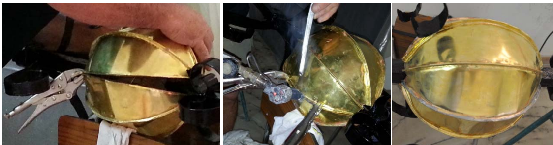
Grupo de imágenes 6.588 Proceso de montaje de la bola de latón.
