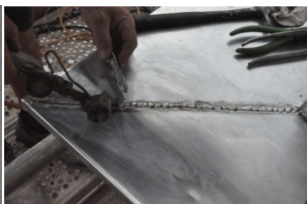
Grupo de imágenes 6.122 Realización de la soldadura final con una cadena de puntos para dilataciones.
