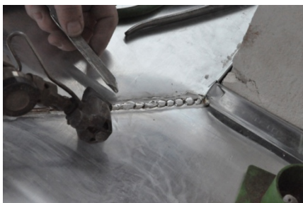
Grupo de imágenes 6.122 Realización de la soldadura final con una cadena de puntos para dilataciones.
