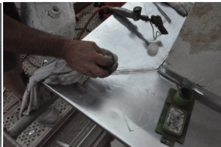
6.120 Cordón soldadura. 6.121 Decapante.
