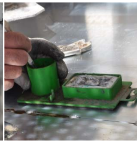
6.117, 6.118 Aplicación líquido para soldadura.
