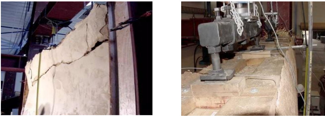
Fig.12 Imágenes sobre ensayos de carga sobre muros de balas de paja revocados con morteros de arcilla y de cal. www.strawbalebuilding.ca
