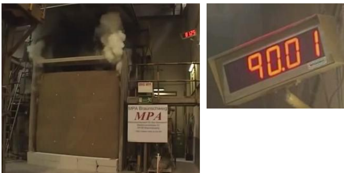
Fig. 15 Imágenes del ensayo de resistencia al fuego por MPA, realizado en Alemania por FASBA. www.fasba.de
