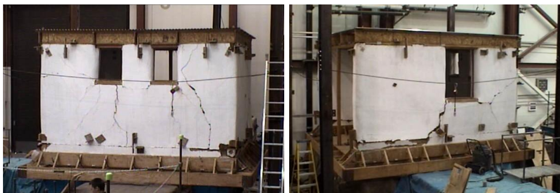
Fig. 14 Imánes sobre el test sísmico realizado en la Universidad de Nevada, Reno www.nees.unr.edu/projects/straw-house
