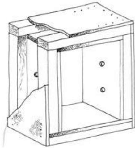
Fig. 62 Dibujo de cajón de ventana para sistema Nebraska – Maren Termens del libro Casas de paja .
