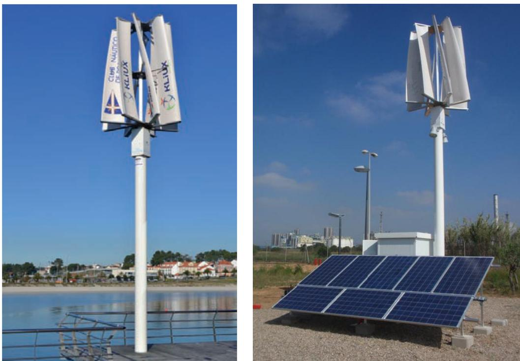
*Fig. 4.31 –Aerogenerador Kliux Zebra y sistema híbrido eólico – solar Kliux*
