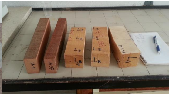
Figura 2.47: Probetas debidamente cortadas y preparadas para dimensionar, pesar y posteriormente introducirlas en la estufa a 100°C.
