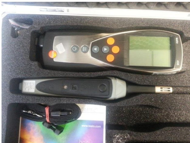
Figura 2.73: Testo, la parte superior es la receptora de datos y la inferior es la que se coloca en el interior del recipiente de forma inalámbrica.
