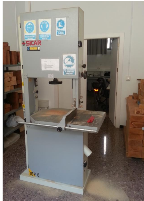
Figura 2.19: Sierra de cinta circular utilizada para cortar y redimensionar todas las probetas aportadas inicialmente.
