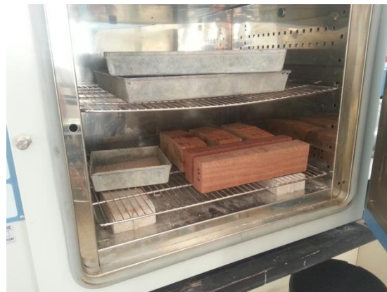
Figura 2.50 y 2.51: Estufa proporcionada por el laboratorio de materiales para llegar a Peso constante en las probetas, con una temperatura de 100°C.
