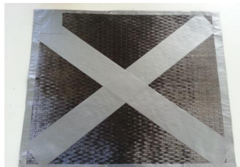
Figura 2.7: Malla de Carbono para mejorar la medición sobre la superficie de las maderas, con ayuda de un gel conductor.
