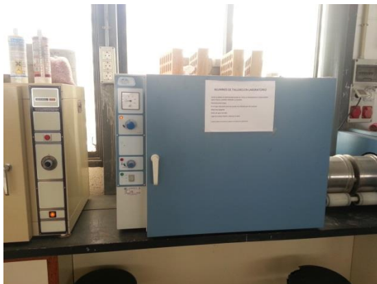
Figura 2.50 y 2.51: Estufa proporcionada por el laboratorio de materiales para llegar a Peso constante en las probetas, con una temperatura de 100°C.
