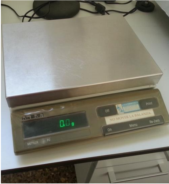
Figura 2.14: Balanza de precisión utilizada para pesar las primeras probetas.
