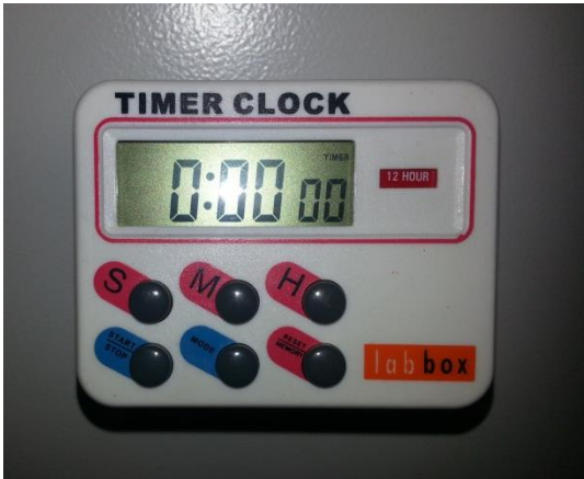
Figura 2.23: Cronómetro utilizado para controlar el tiempo con respecto al incremento de peso que se producen en los ensayos.
