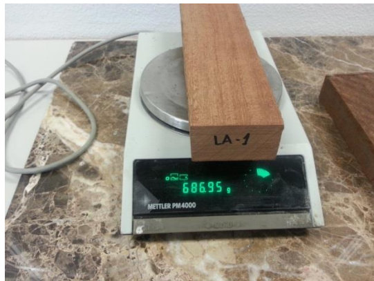
Figura 2.48 y 2.49: Ejemplo de pesada inicial de dos probetas: Pino Silvestre (PS-1-1) y Lauan (LA-1).
