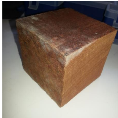
Figura 2.85: Aquí podemos observar la muestra LA-22 después de adsorber humedad durante 22 días.
