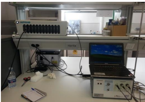
Figura 2.6: Aparato de medición, espectrómetro de impedancia.
