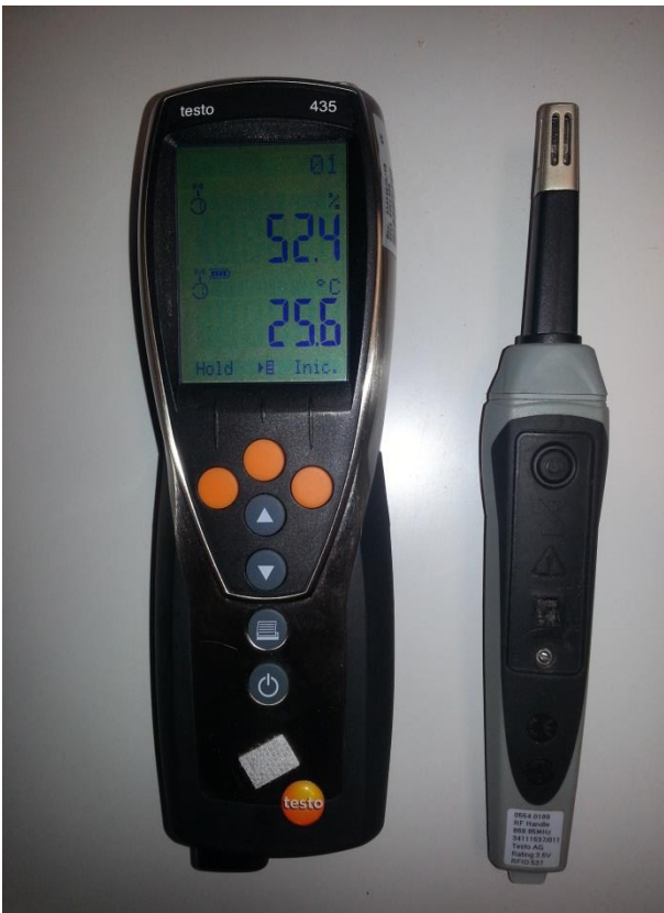
Figura 2.24: Testo 435. En la izquierda el visualizador y receptor de datos. A la derecha la sonda inalámbrica.
