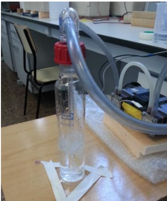
Figura 2.26: Borboteador y conexiones con tubo de plástico.
