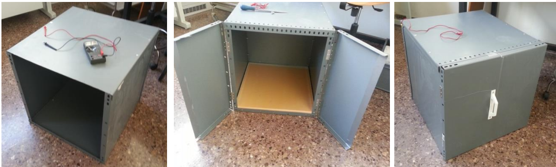
Figura 2.1, 2.2, 2.3: Construcción de una jaula de Faraday partiendo de una estantería de metal, con puesta a tierra, dos puertas abatibles, una base no conductora y cómoda, etc.
