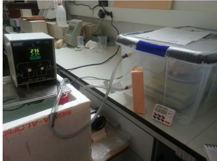
Figura 2.72: Este es el instrumental de medición final, con todos los cambios, con la posterior introducción del higrómetro inalámbrico.
