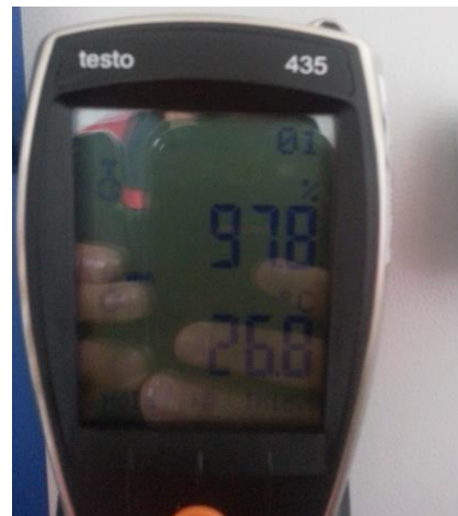
Figura 2.74: El Testo 435 aporta datos de Humedad (%) y Temperatura (° C) del interior del recipiente.
