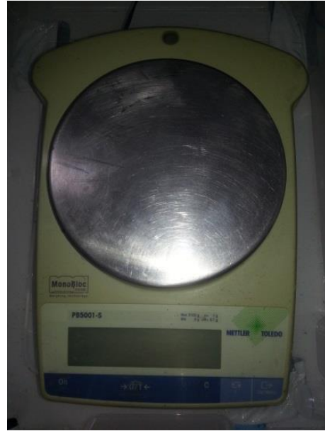
Figura 2.15: Balanza de precisión utilizada en los ensayos.
