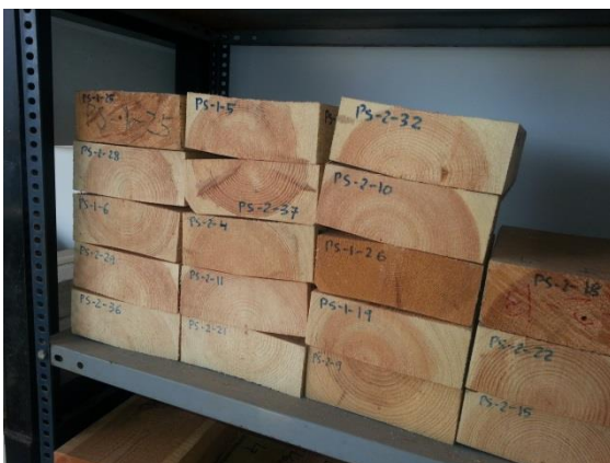
Figura 2.36: Probetas de Pino Silvestre.
