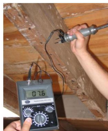
Figura 1.2: Estimación de la humedad en una viga de madera (Bobadilla, I).
