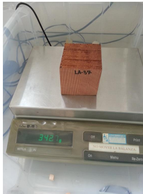
Figura 2.57: Pesado de una de las probetas de Lauan, en este caso LA-37. De esta misma manera procedemos con todas las probetas de Lauan.
