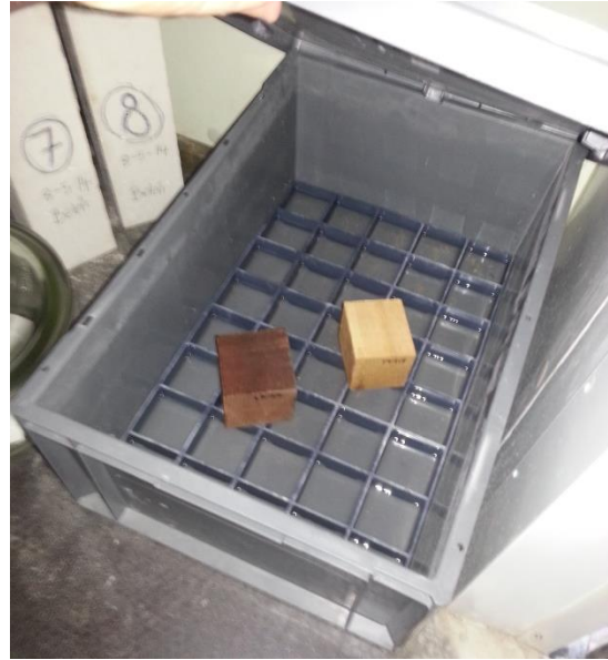
Figura 2.33: Recipiente abierto, rejilla en la base interior.
