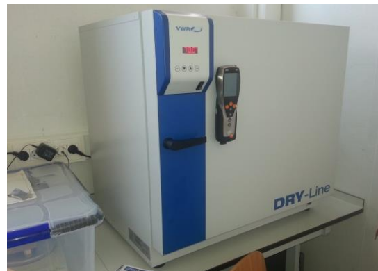
Figura 2.17: Estufa del laboratorio de química. Utilizada en todo los ensayos finales.
