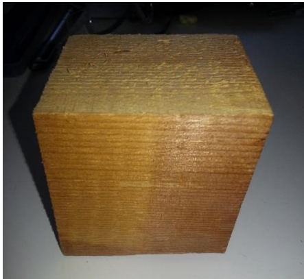
Figura 2.84: Aquí podemos observar la muestra PS-1-1 después de adsorber humedad durante 22 días.
