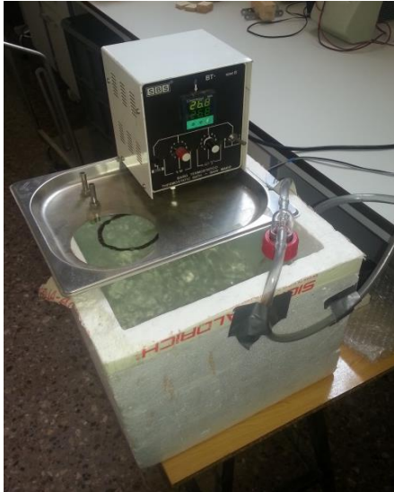
Figura 2.71: Colocación de un calentador de agua para mantener el borboteador a la misma temperatura que el interior del recipiente.
