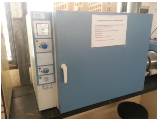
Figura 2.16: Estufa del laboratorio de materiales. Utilizada para los primeros secados.
