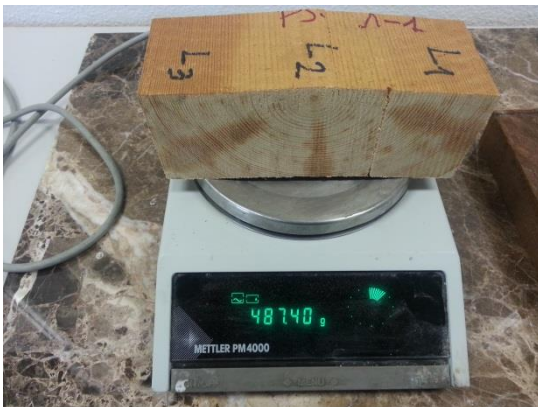
Figura 2.48 y 2.49: Ejemplo de pesada inicial de dos probetas: Pino Silvestre (PS-1-1) y Lauan (LA-1).
