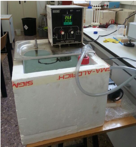
Figura 2.28: Calentador de agua, con botones para subir o bajar la temperatura, con pantalla digital.
