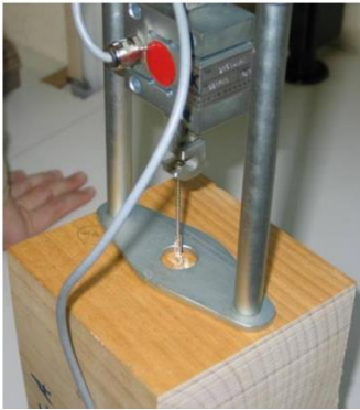
Figura 1.4: Detalle ensayo Máquina de arranque de tornillos (Bobadilla, I.)
