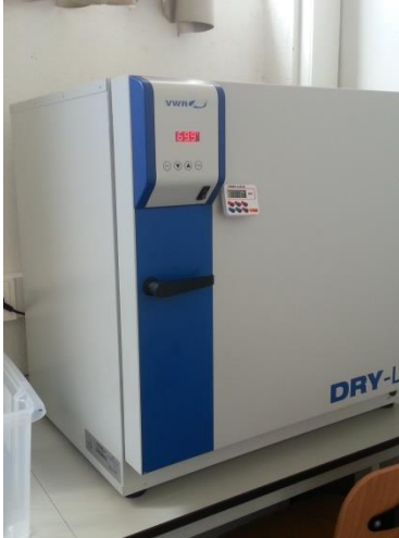
Figura 2.58: Estufa proporcionada por el laboratorio de Química a 70° C.
