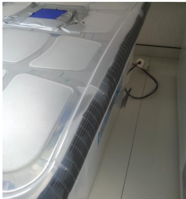
Figura 2.21 y 2.22: Caja de plástico en la izquierda y en la derecha con un añadido para mejorar la hermeticidad de la cámara.
