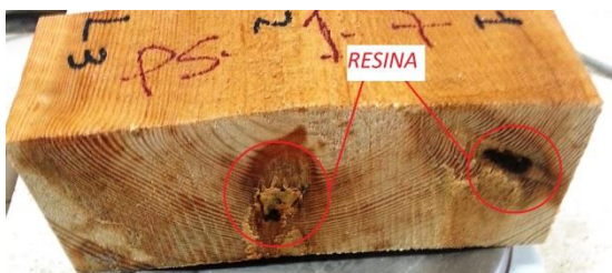
Figura 2.52 y 2.53: Se puede apreciar como la resina sale a la superficie por los nudos, poros, fisuras, etc. Debido al secado de las probetas a alta temperatura (100°C).
