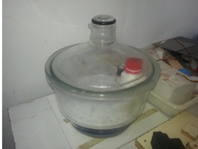
Figura 2.59: Desecador, donde metemos las probetas nada más sacarlas de la estufa para que se enfrien sin coger humedad.
