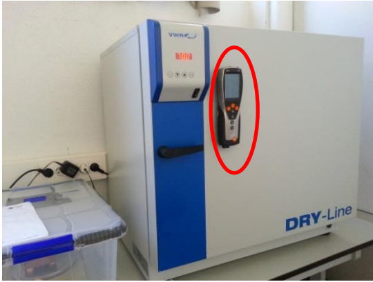
Figura 2.75: Así quedaría el testeo a la hora de coger datos, aprovechando que posee un imán.
