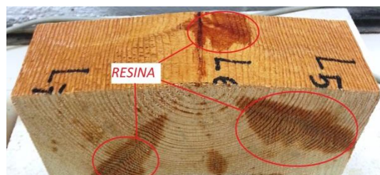
Figura 2.52 y 2.53: Se puede apreciar como la resina sale a la superficie por los nudos, poros, fisuras, etc. Debido al secado de las probetas a alta temperatura (100°C).
