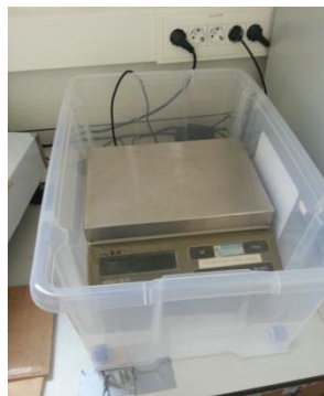
Figura 2.64: Balanza equilibrada, introducida en el interior del recipiente hermético.
