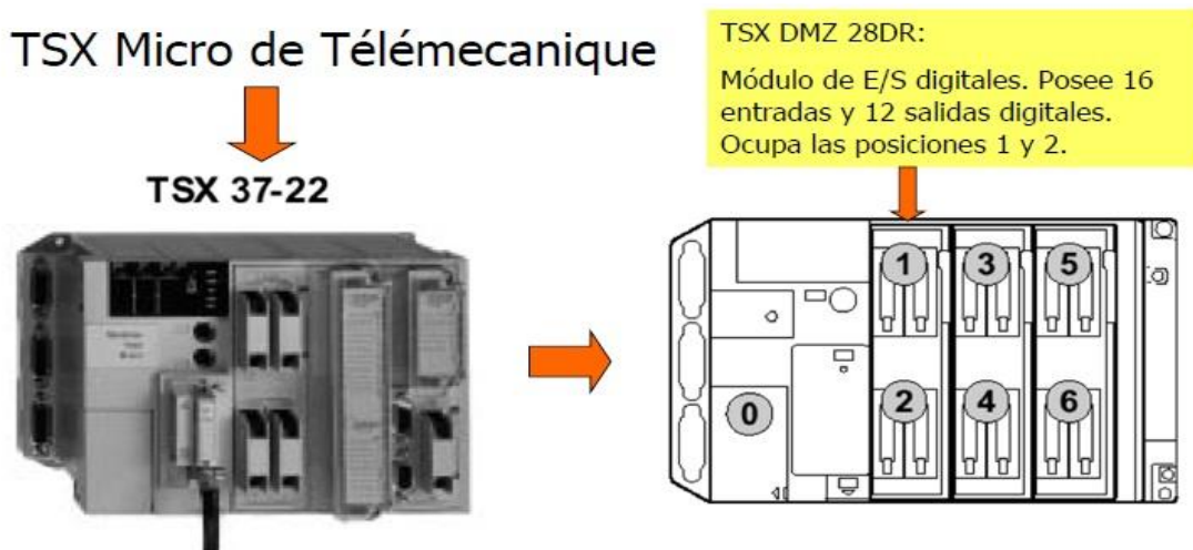
Ilustración 6. Módulos de entrada/salida del PLC
