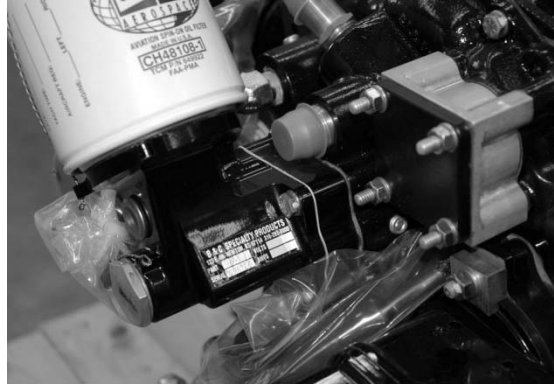
Figura 2.9. Bomba de Aceite de Motor de Combustión Interna.
