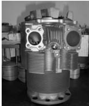
Figura 2.3. Cilindro de un Motor modelo IO-360 de Teledyne Continental Motors
