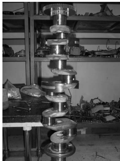
Figura 2.8. Cigüeñal de un Motor de Combustión Interna.
