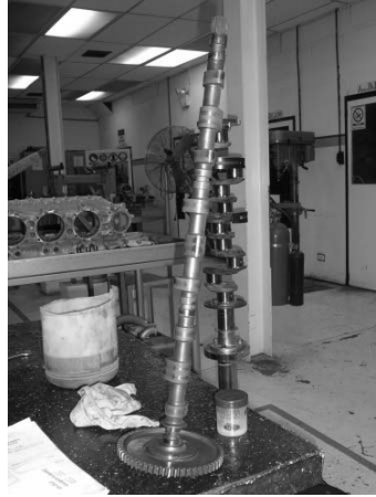
Figura 2.7. Árbol de levas Motor de Combustión Interna.
