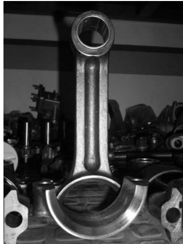
Figura 2.5. Biela de Motor de Combustión Interna.
