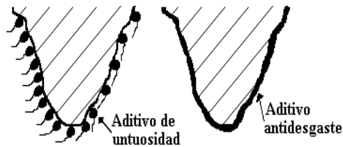
Figura 3.10. Acción de los aditivos antidesgaste sobre las superficies (Albarracín, 2003).
