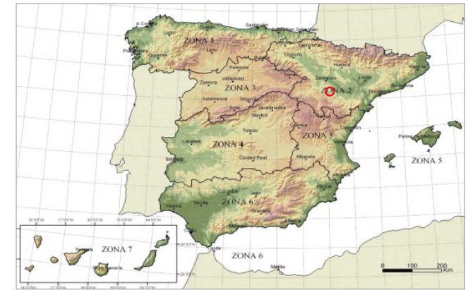
Sobrecarga de nieve. Código Técnico de la Edificación SE-AE
