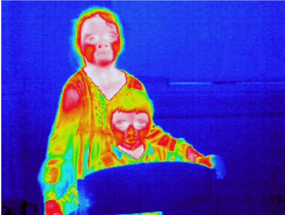
Figura 4.15: NEC TH7800. Termografía infrarroja, paleta Shine. Zonas claras en el rostro “a modo de antifaz”
