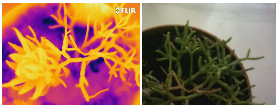
Figura 2.46: Flir T600. Termografía infrarroja, paleta Iron, y fotografía. Teniendo la referencia fotográfica es más fácil interpretar la termografía infrarroja
