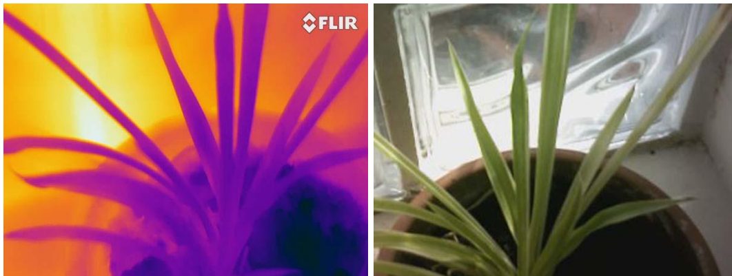
Figura 2.47: Flir T600. Termografía infrarroja, paleta Iron y fotografía. La forma se aprecia por el contraste que se establece entre la figura y el fondo, aunque el tipo de contraste difiera entre las dos imágenes
