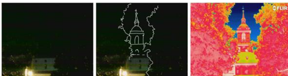
Figura 2.5: Flir T640, fotografía, fotografía y dibujo, termografía infrarroja, paleta Rain 900
