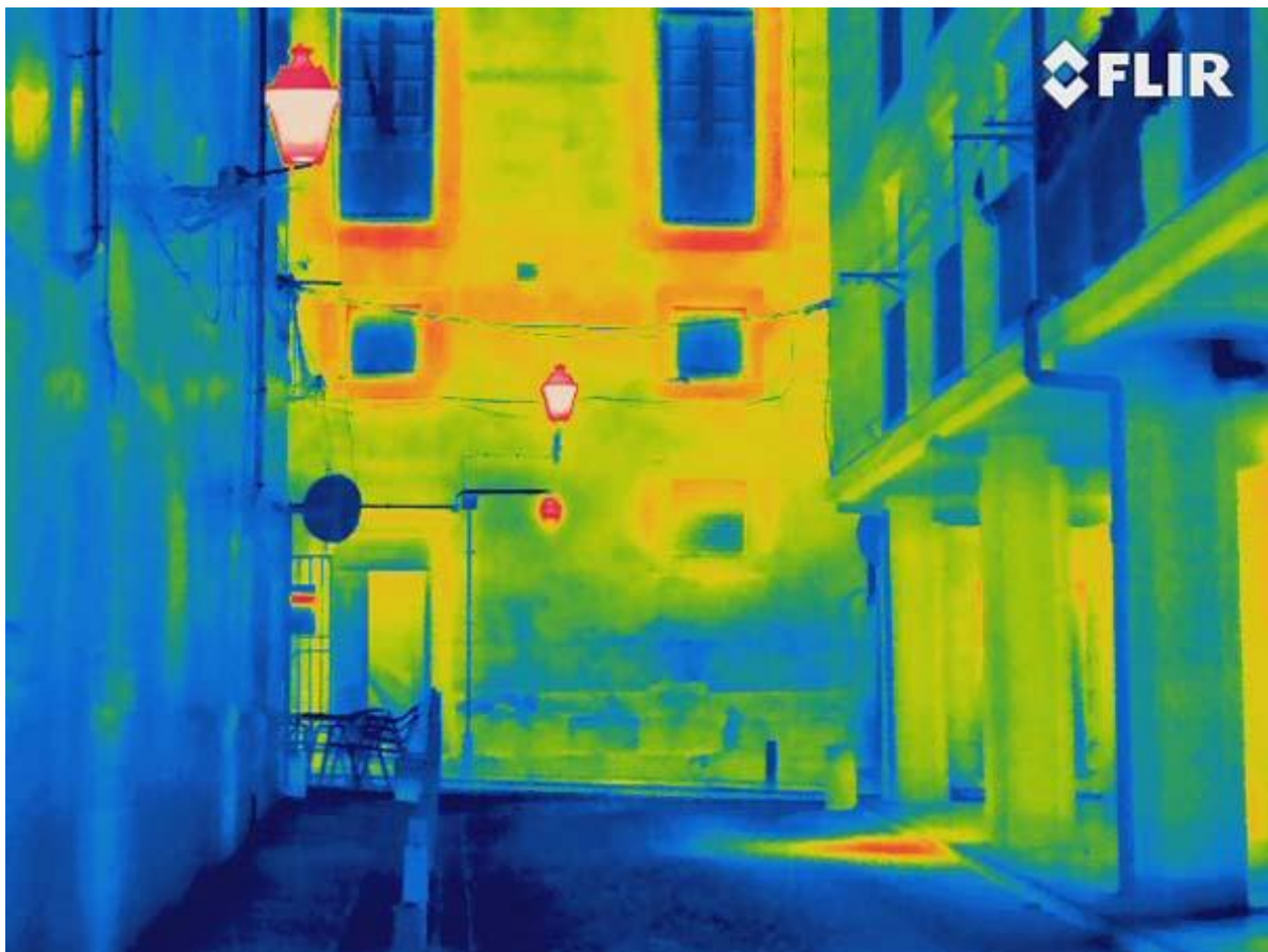
Figura 3.50: Flir T640, termografía infrarroja, paleta Rain 900. Calle de San Lorenzo de El Escorial (Madrid)
