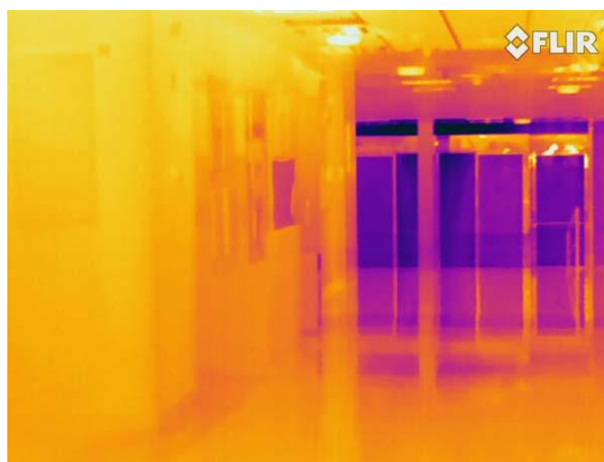
Figura 2.37: Flir T600. Termografía infrarroja, paleta Iron. Planos que dividen la imagen
