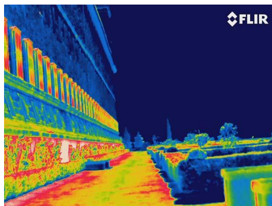
Figura 3.29: Flir T640, termografías infrarrojas, paleta Rain 900 Imagen en la que el cielo presenta un único color
