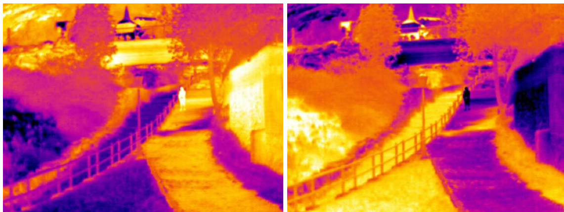
Figura 5.2: NEC TH7800, termografía infrarroja. Estas imágenes muestran la anterior, una vez ajustado el campo, reproducida con distintas paletas
