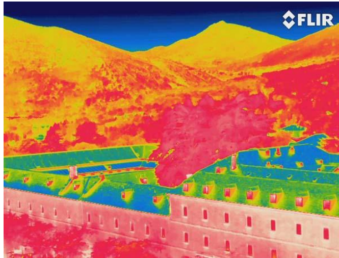
Figura 3.35: Flir T640, termografía infrarroja, paleta Rain 900 La vegetación en la imagen térmica se convierte en una lengua roja que avanza sobre el edificio
