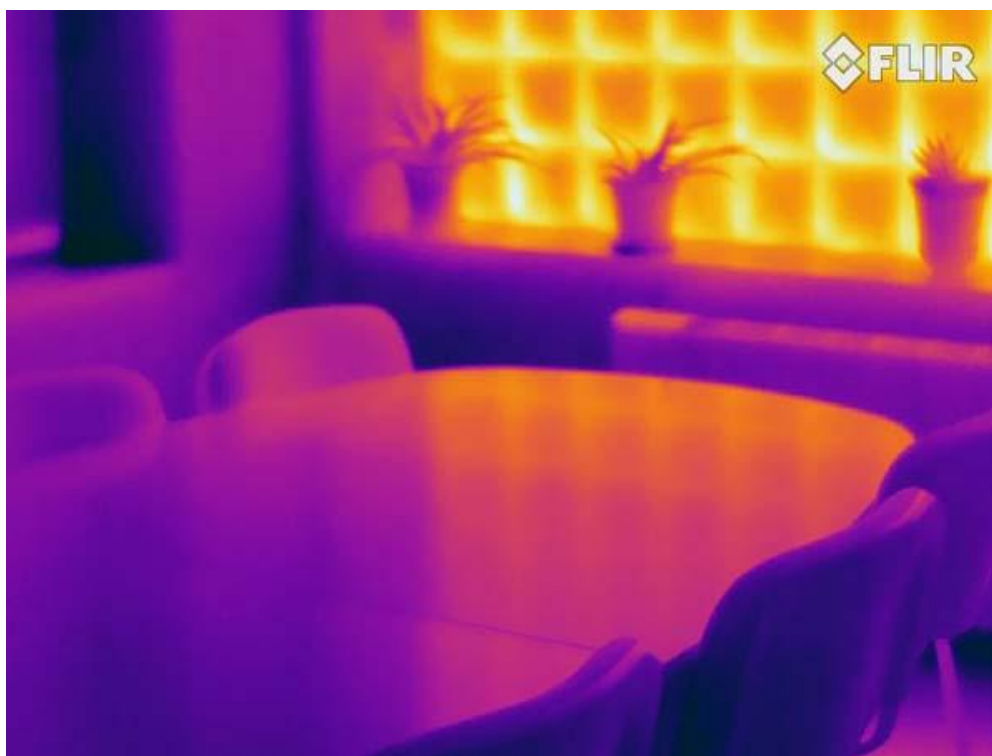
Figura 2.86: Flir T600. Termografía infrarroja, paleta Iron. No sólo a las superficies brillantes pueden hacernos suponer que el calor se va a reflejar
