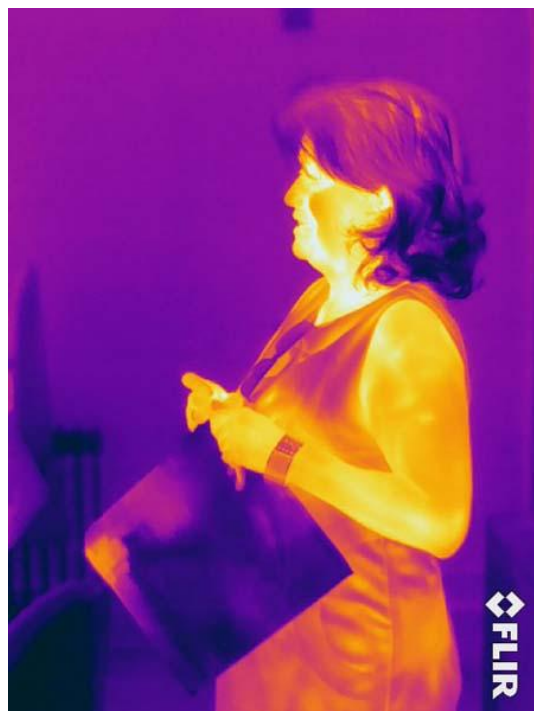
Figura 2.93: Flir T600. Termografía infrarroja, paleta Iron El sobre muestra claramente la huella de quien lo ha entregado
