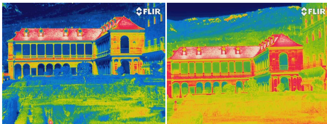
Figura 3.8: Flir T640, termografías infrarrojas, paleta Rain 900. La inclusión del cielo y el perfil del monte que en principio debería aportar mayor profundidad en la segunda imagen, da como resultado una representación más plana. Pese a los colores cálidos, el primer plano pierde definición y contraste.
