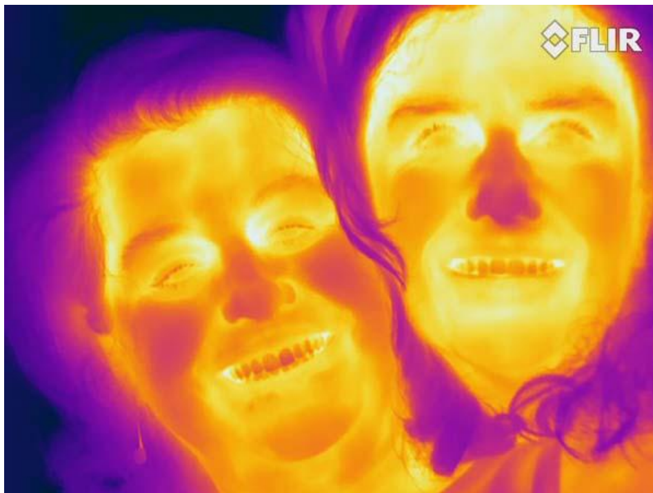
Figura 4.16: Flir T640, termografía infrarroja, paleta Iron. Rostros en los que se observan las pestañas y las cejas pero no el interior del ojo
