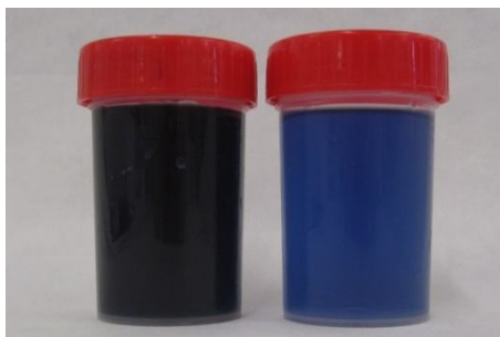
Figura IV.43. Muestra de efluente textil sintético antes y después de la UF con la membrana INSIDE CéRAM™ 1 kDa.
