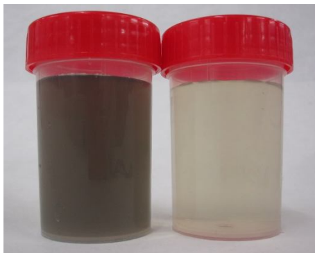
Figura IV.46. Muestra de efluente textil real antes y después de la UF con la membrana INSIDE CéRAM™ 1 kDa.
