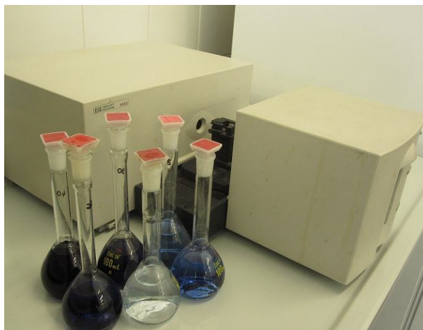
Figura III.18. Espectrofotómetro UV-Visible y disoluciones de RB5 de distintas concentraciones para la obtención de la curva de calibración.
