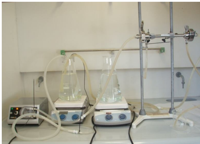
Figura III.20. Montaje para el acondicionamiento inicial de las membranas.
