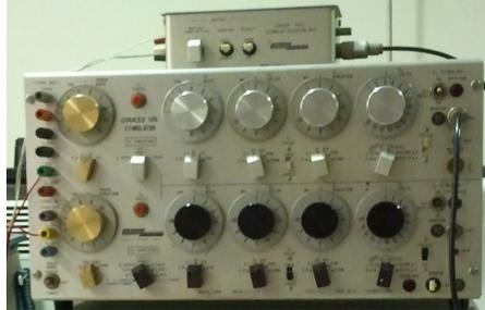
**Figura 2.1.** Estimulador Grass, modelo S88, utilizado en los experimentos desarrollados durante esta Tesis Doctoral.
