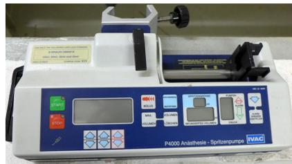
**Figura 2.5.** Bomba de infusión IVAC-P4000, como la utilizada durante los experimentos llevados a cabo en esta Tesis Doctoral.
