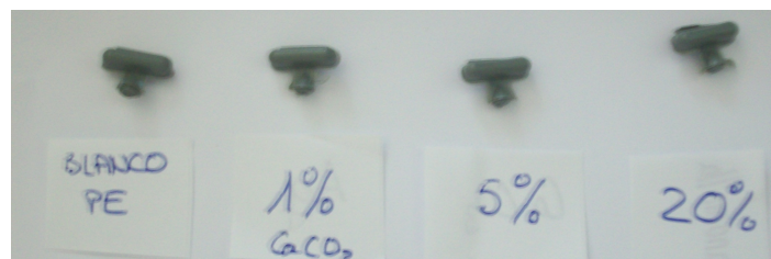
Figura 18. Aspecto visual de las muestras de PE reciclado con nanoCaCO 3 al 1%, 5% y 20%
