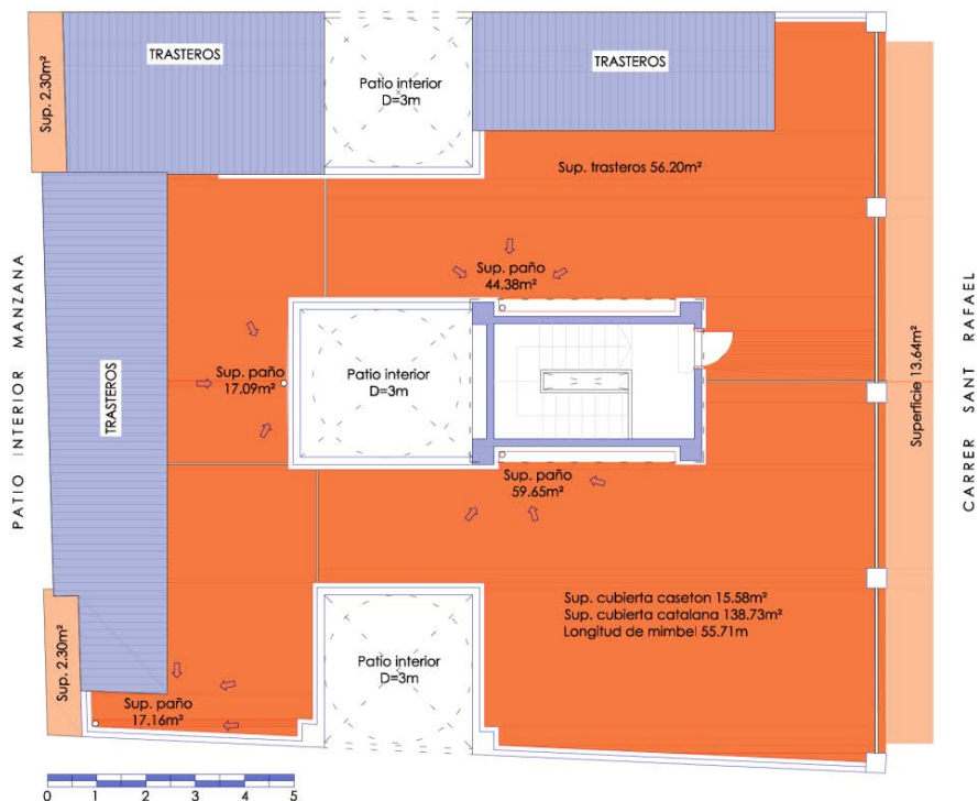
Imagen 15. Planta de cubierta del edificio objeto.
