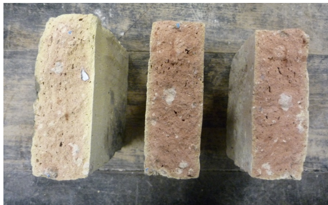
Piezas fracturadas por el ensayo de flexión para observar el interior de la pieza
