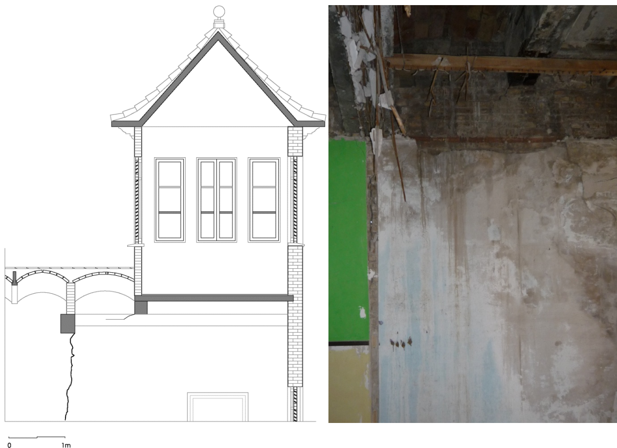
Apoyo en el muro de la viga I
