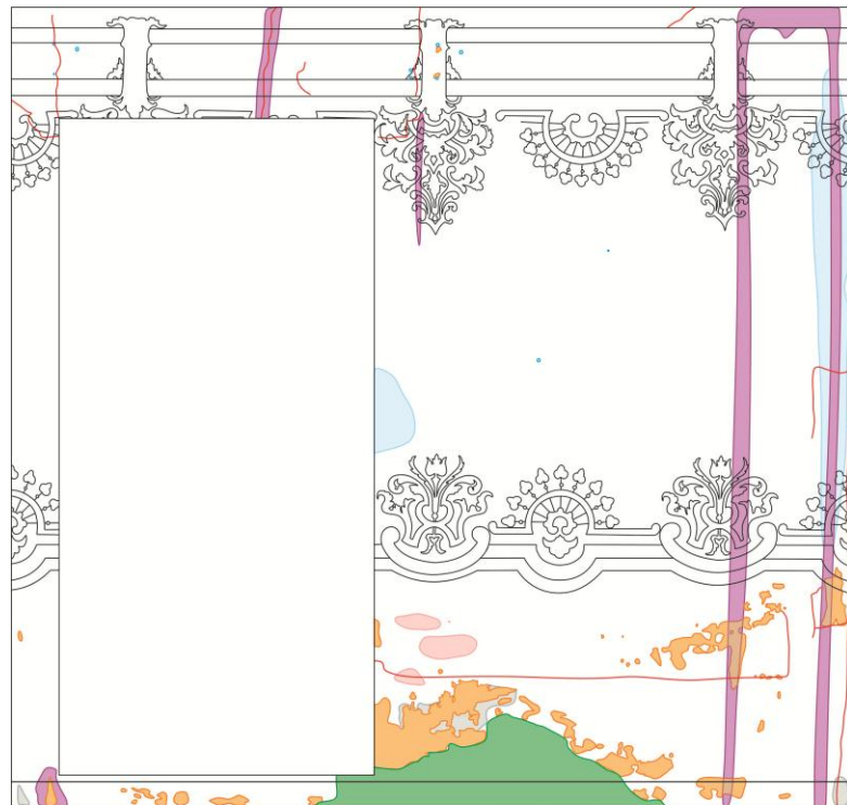
Il·lustració 3: diagrama de danys de les pintures corresponents al mur que conté la finestra.
