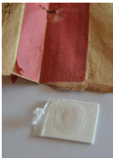
Imagen 17. Prueba de solubilidad del tinte del margen de refuerzo.
