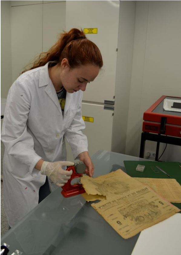
Imagen 1. Medición del espesor de los documentos empleando un micrómetro.
