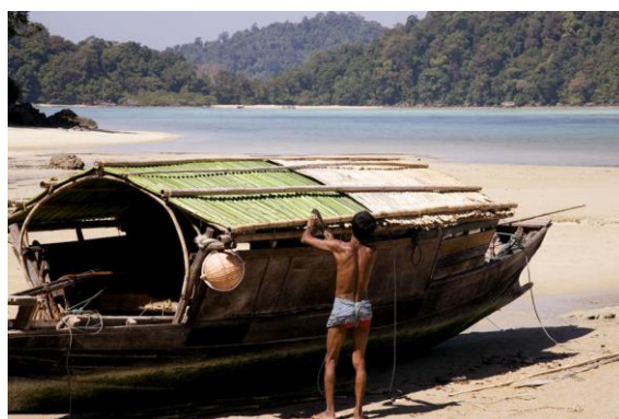
Ilustración 61: Cambio de techo de un Kabang del pueblo Monken. Fuente: C. Vinton (2009).
