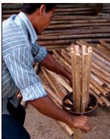
Ilustración 131: Latillado manual de la caña guadua. Fuente: http://laarquitectura.blogspot.com.es/2011/02/construcciones-de-viviendas-con-cana.html (Consulta: 06/04/14).
