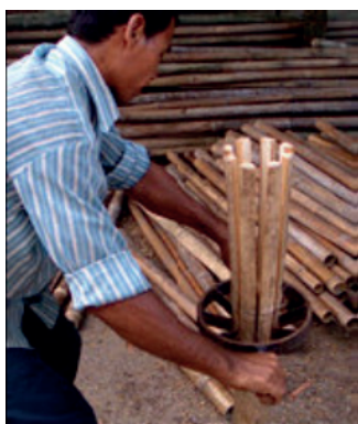
Latillado manual de la caña guadua. Fuente: http://laarquitectura.blogspot.com.es/2011/02/construcciones-de-viviendas-con-cana.html
