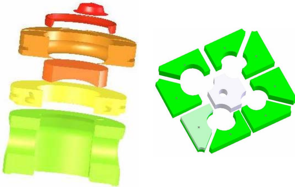
Figura 3.25. Nodalización del pistón y de la cara de la culata en contacto con los gases.
