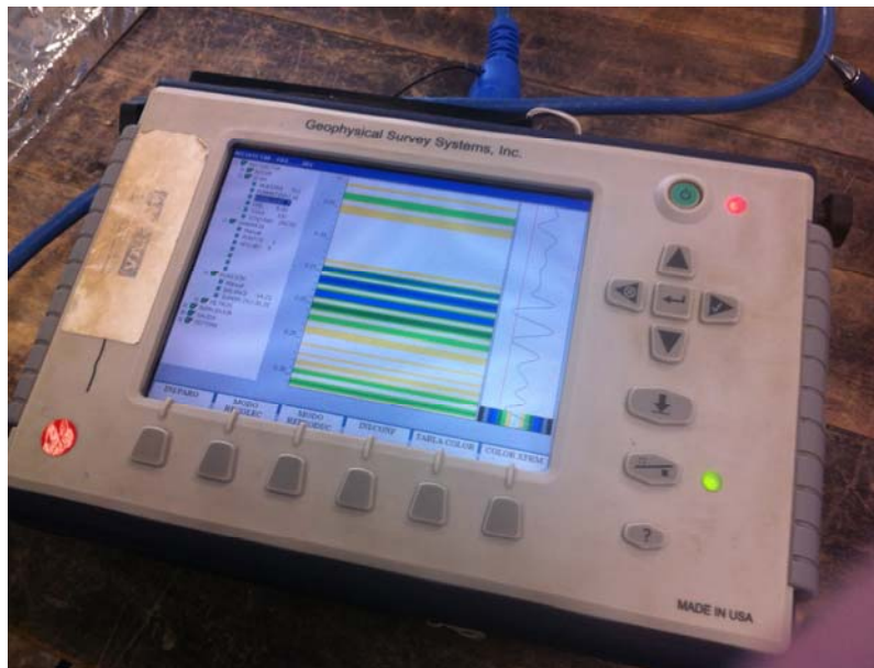
Figura 4. Representación por colores de un registro de georadar
