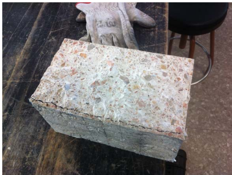
Figura 23. Marca de la huella de penetración de agua
