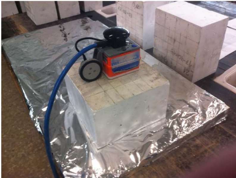
Figura 18. Dispositivo para la adquisición de registros por medio de antena de 2 GHz
