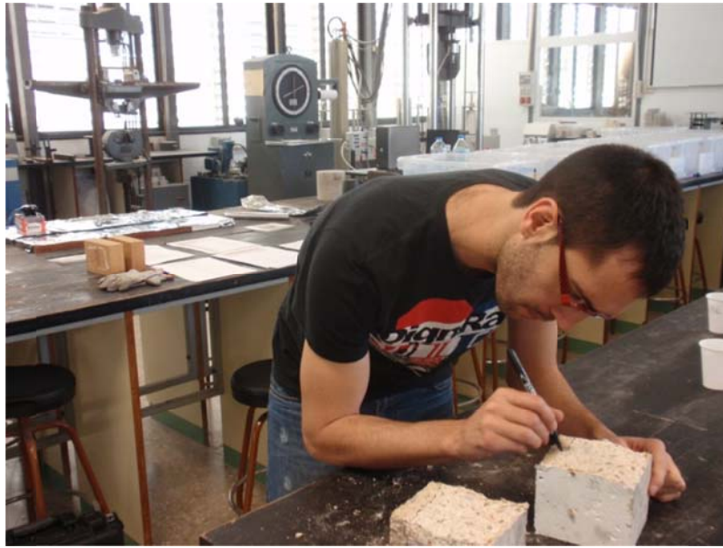
Figura 21. Rotulación del frente de penetración de agua
