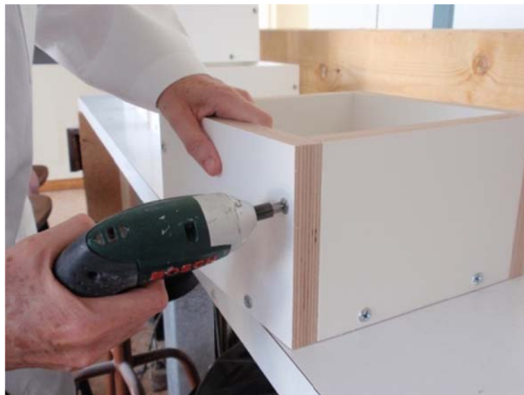
Figura 5. Montaje de los moldes para la fabricación de las probetas
