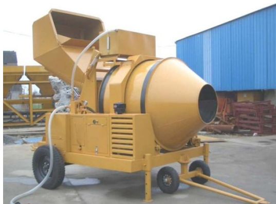
Ilustración 38. Hormigonera Alice r500. 2014 .Alice.
