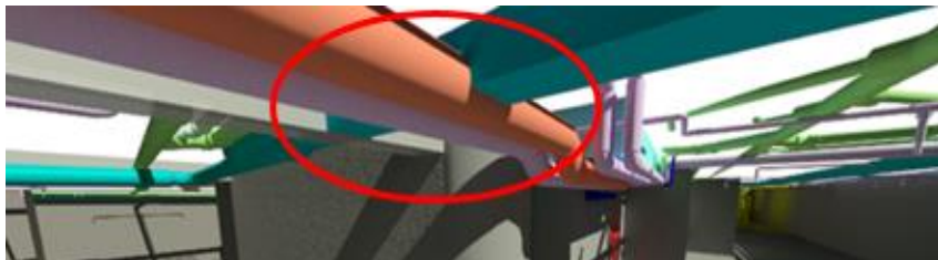
Figura 9. Detección de colisiones. 2014. http://www.bimworks.cl/spa/wp-content/uploads/2014/02/WEB-REPORTE-COLISION1.png
