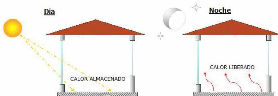
Imagen 3.12. Funcionamiento de la masa térmica en invierno. Fuente: Pastormerlo y Souza, 2013
