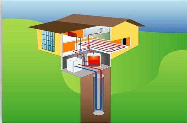
Imagen 4.4. Sonda geotérmica. Fuente: web 48.
