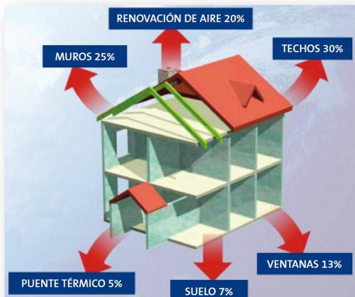
Imagen 3.4. Pérdida de energía en la edificación. Fuente: Catálogo ISOVER “Aislamiento de Fachadas”
