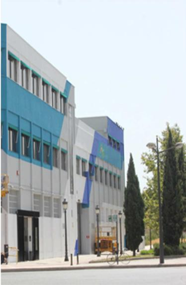
La fachada Suroeste tiene quince ventanas en la primera, y nueve en la segunda planta, distribuidas simétricamente a lo largo del muro sin apenas separación horizontal entre ellas. Estas ventanas son de PVC, formadas por dos hojas correderas de cristal cada una. Todas ellas con toldos de color verde oscuro (*fig.18*).
