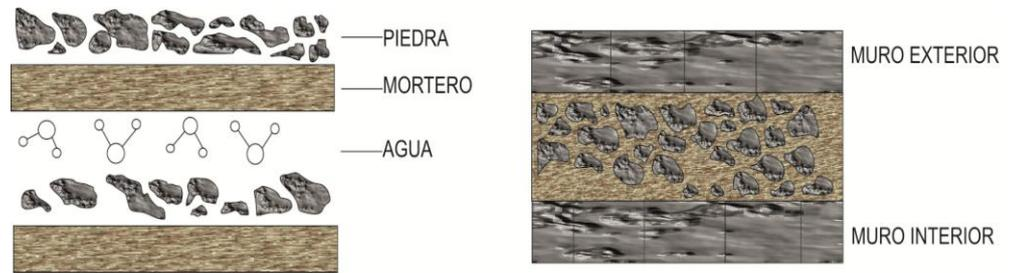
Fig. 16 Vista estratificada del relleno entre muros; a la derecha, vista superior del relleno. Realizado por el autor del texto.
