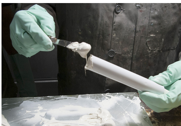
Entubar la pintura y cerrar el tubo
