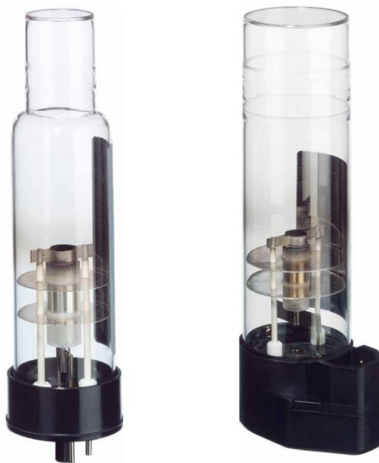
Figura 33. Lámparas de cátodo hueco de distintos diámetros 37mm (izquierda y 50mm (derecha) [96].
