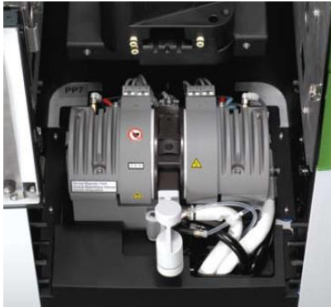
Figura 32. Detalle del horno de grafito de un espectrómetro de absorción atómica PerkinElmer PinAAcle 900Z [93].
