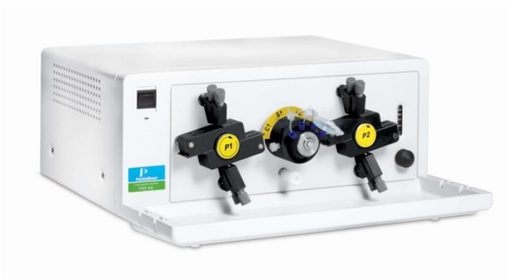
Figura 28. FIAS 100 sistema por inyección de flujo para absorción atómica de PerkinElmer [91].
