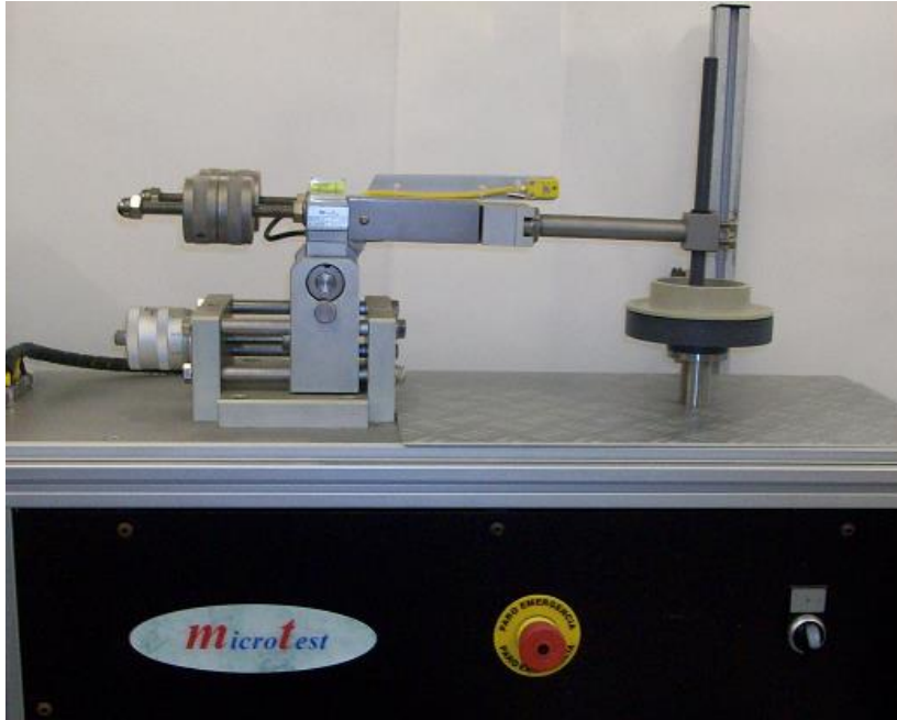
Figura 38. Tribómetro Ball-on-Disk de la casa Microtest S.A., modelo MT 60/Nl/CORR.
