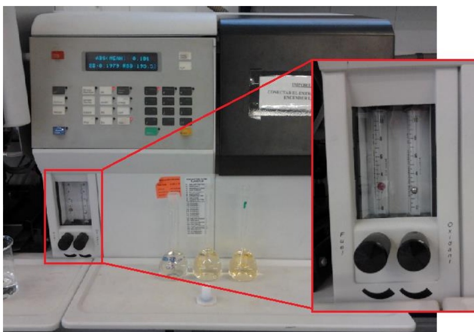
Figura 43. Detalle de los caudalímetros de fuel y aire en el equipo de absorción atómica.
