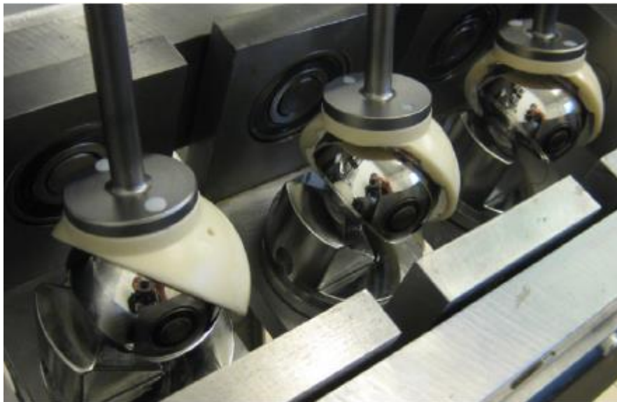
Figura 18. Simulador de cadera sin cámara de lubricación [55].
