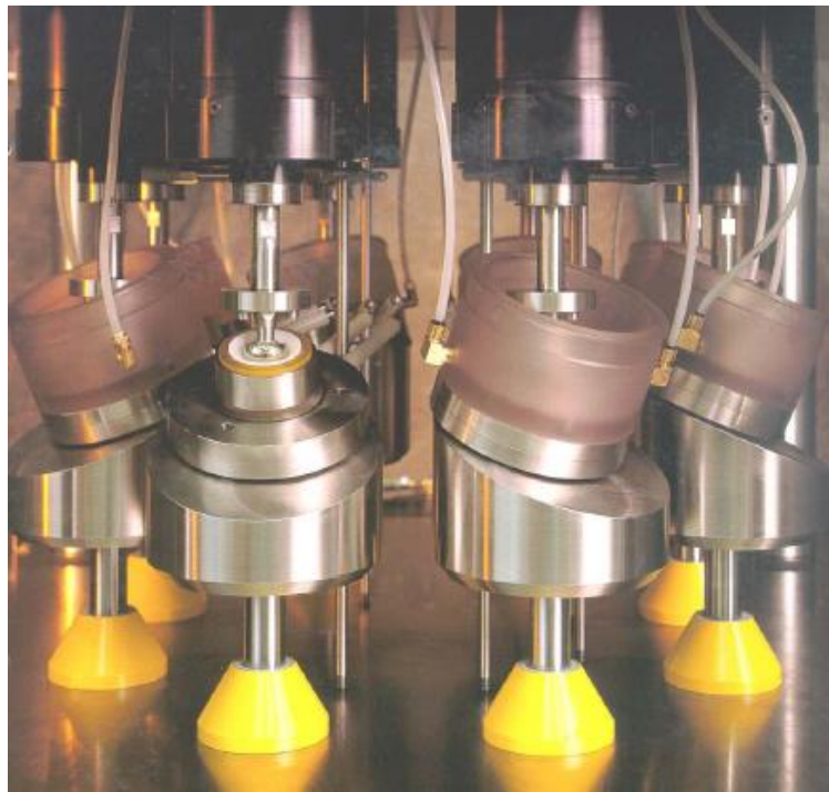
Figura 16. Simulador de desgaste de cadera de movimiento biaxial.
