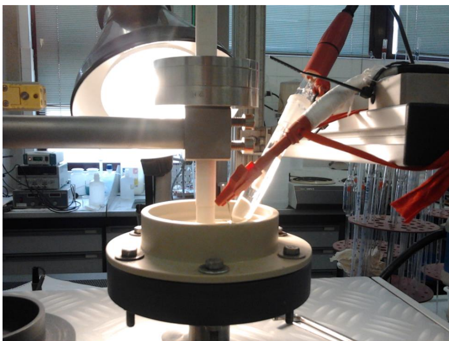
Figura 40. Disposición de los electrodos en la celda electroquímica.
