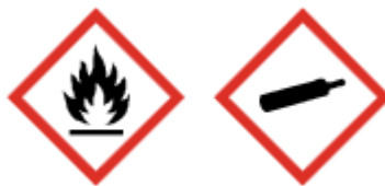
Figura 1: Pictogramas de peligrosidad para el propano y el butano comercial. Fuente: Cepsa.
