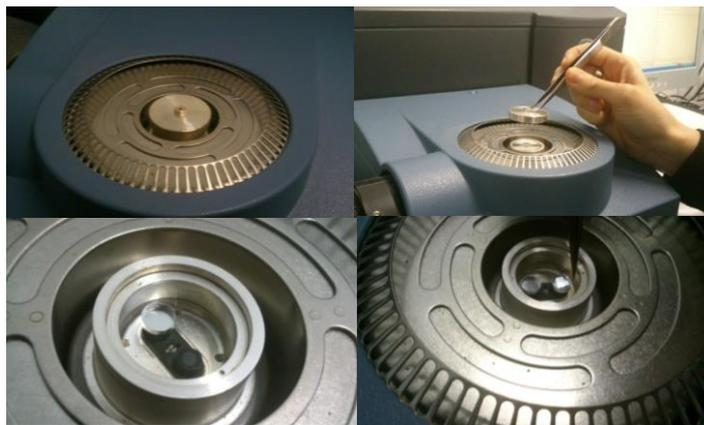
**Figura 3.9:** Imágenes de ubicación de ambas cápsulas (referencia/muestra) en el DSC Q-20 TA-Instruments empleado
