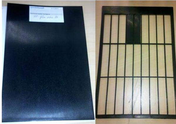
**Figura 3.14:** (a) *Muestras recibidas de la empresa LyondellBasell.* (b) *Muestras cortadas con dimensiones adecuadas para las medidas del DMA.*
