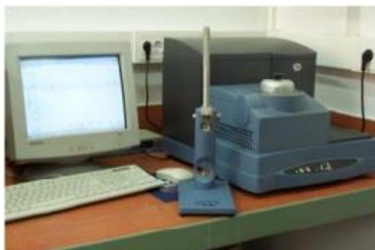
**Figura 3.8:** Imagen del Analizador Térmico DSC Q-20 TA-Instruments empleado
