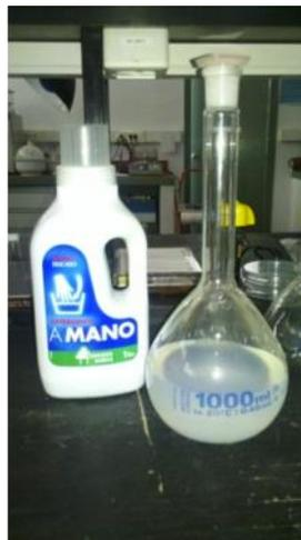
**Figura 3.16:** Botella del jabón empleado para el test de resistencia y matraz con la disolución de detergente al 5% en peso
