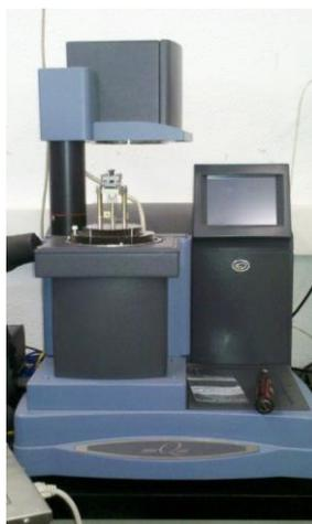
**Figura 3.11:** *Equipo de Análisis Dinamomecánico. DMA Q-800 de TA Instruments*
