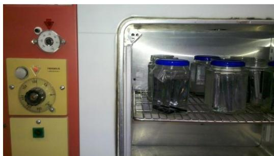
**Figura 3.17:** *Probetas en los viales con agua y disolución de detergente dentro de la estufa*
