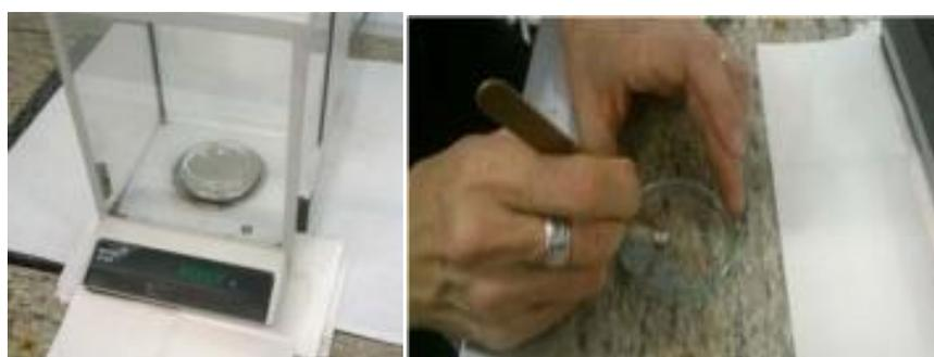
**Figura 4.2.** Balanza y colocación de la muestra en la cápsula con pinzas.
