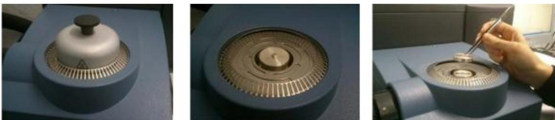
**Figura 4.4.** Retiro de las tapas del DSC para la posterior colocación de la cápsula con la muestra.
