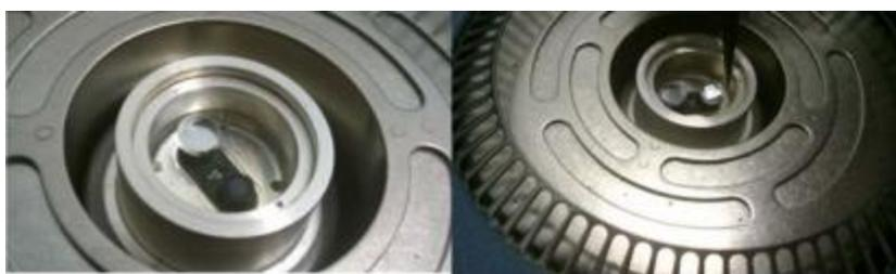
**Figura 4.5.** Colocación de la cápsula con la muestra en el DSC, donde previamente se había colocado la cápsula de referencia
