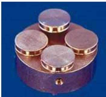
**Figura 3.5.** Portas de cobre que sirven de soporte de las muestras para análisis mediante SEM.
