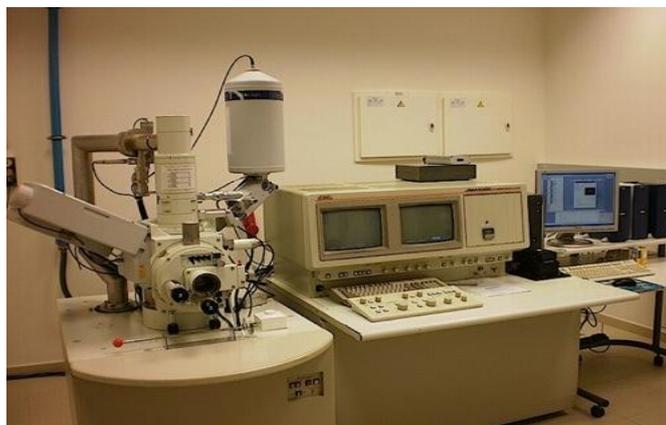
**Figura 3.1.** Imagen de microscopio electrónico de barrido, JEOL MODELO: JSM6300, empleado.
