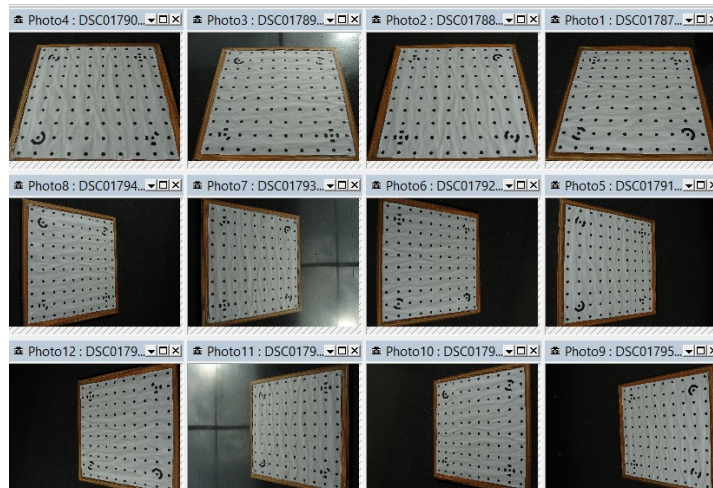
Ilustración 12.- Fotografías de la plantilla de calibración.
