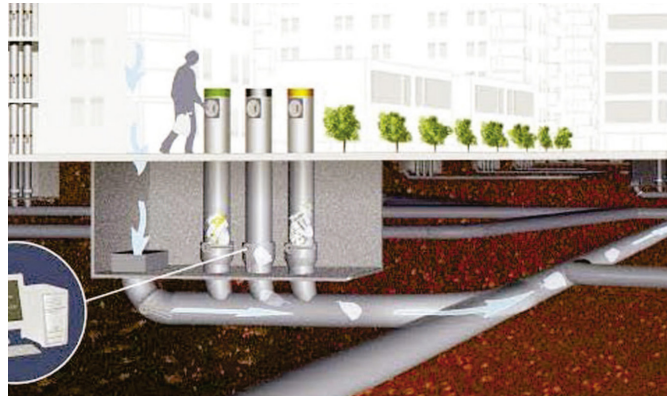
Sistema de separación de residuos
