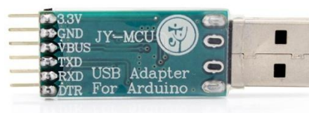
Fig.14.Adaptador puerto USB serie JY-MCU
