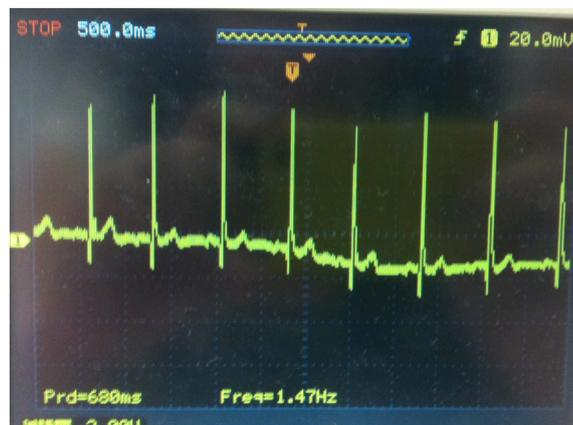
Figura 6.5 ECG sin filtro Notch activado
