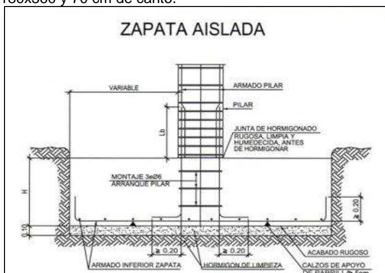
6.1 Imagen zapata aislada
