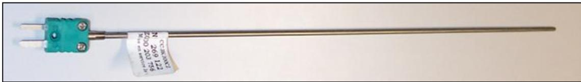
**Figura 4.4: Termopar Tipo k de cabeza cubierta.**
