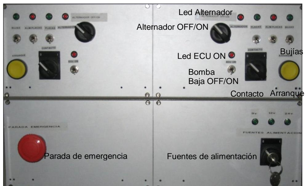
*Figura 4.17: Vista del cuadro de control del motor.*
