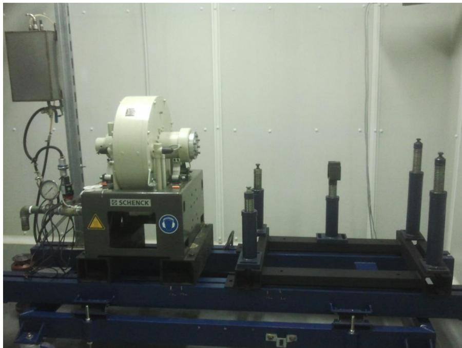
**Figura 3.7: Bancada principal con bancada soporte del motor.**
