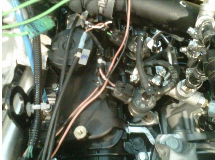
*Figura 4.71: Conexionado para la medida de tensión en los inyectores.*
