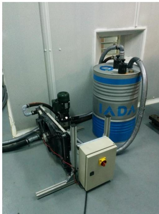
**Figura 3.14: Circuito de refrigeración del freno**
