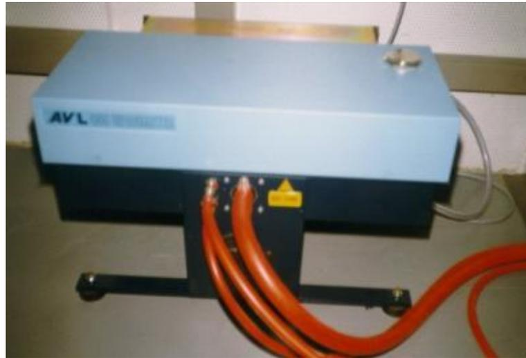
*Fig 4.12: Opacímetro AVL 439.*
