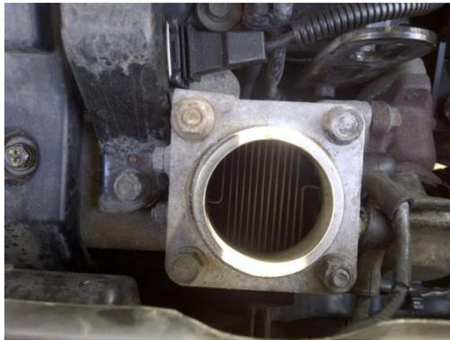
*Figura 2.7: Ejemplo calentador de aire de admisión*
