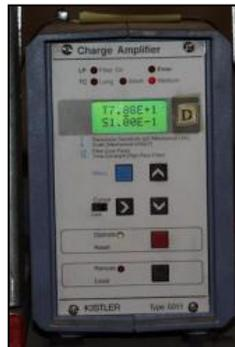
**Figura 4.15: Vista delantera del acondicionador de señal.**
