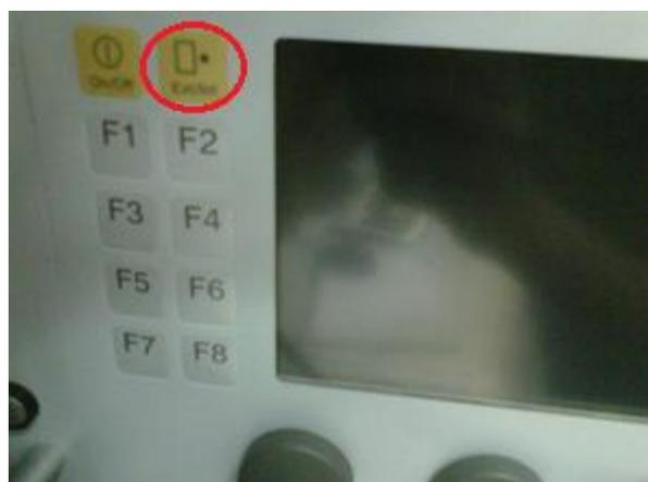
Foto de control electrónico del freno (EXT/INT).
