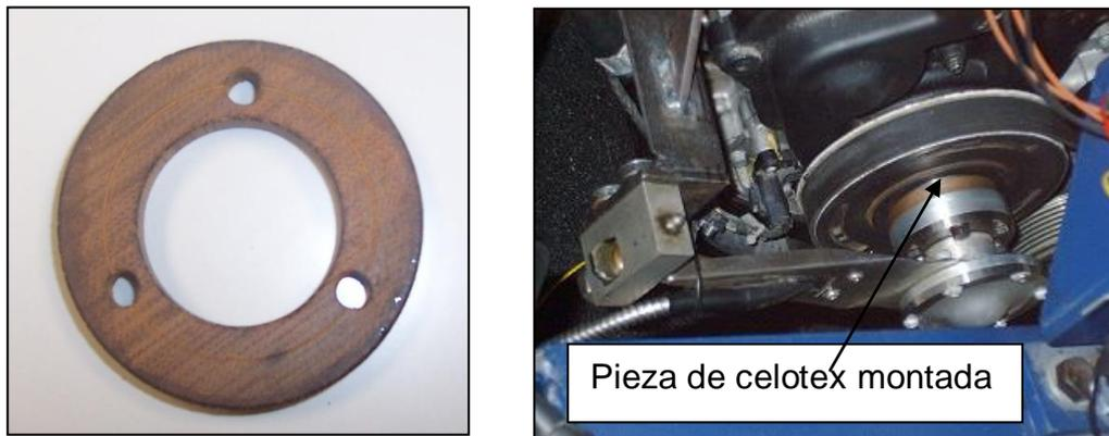
**Figura 4.9: Montaje en el motor del codificador angular.**
