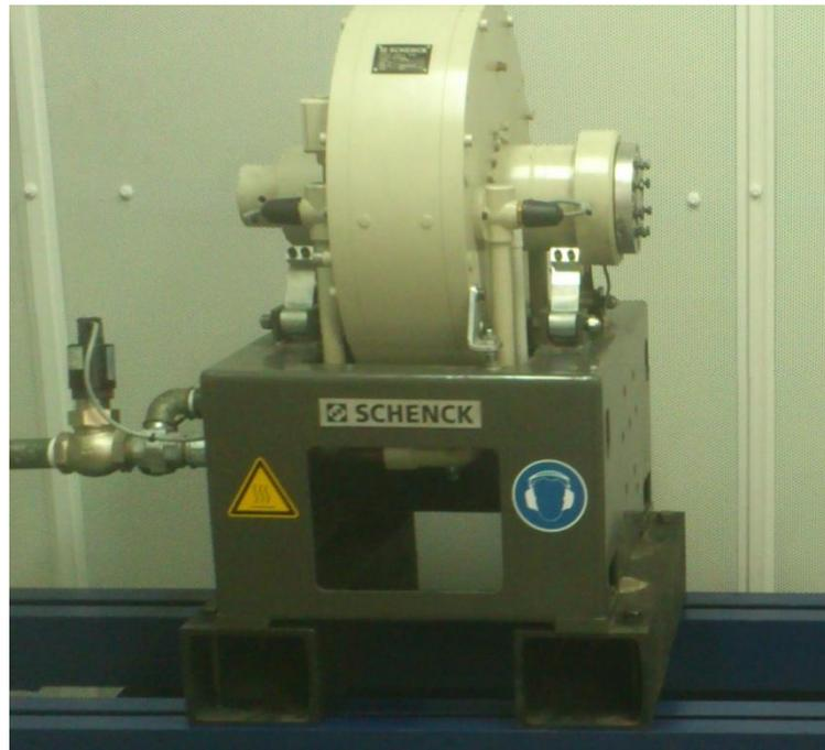
*Figura 3.11: Freno de corriente de Foucault*
