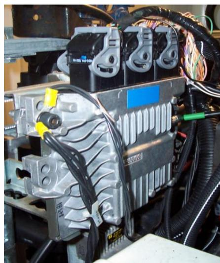
*Figura 3.19: Unidad de control electrónico*
