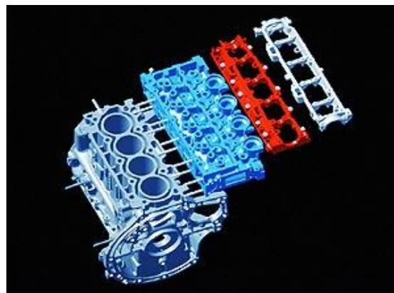
*Figura 3.17: Modelado despiece del bloque motor – tapa de balancines.*
