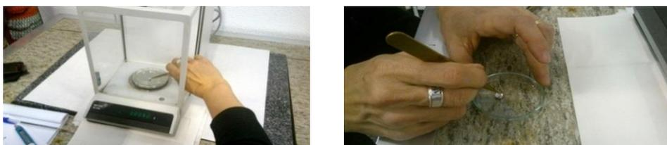
**Figura 5.2.** Imágenes proceso de pesada de muestras en cápsulas de aluminio.
