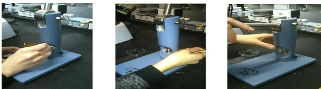
**Figura 5.3.** Imágenes proceso de sellado de las cápsulas de DSC.
