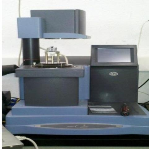
**Figura 4.7.** Equipo de medida empleado en el análisis de DMA.
