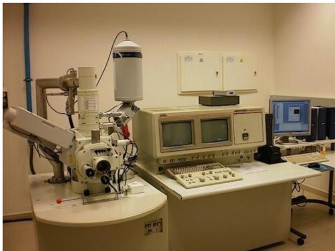
**Figura 4.1.** Microscopio electrónico de barrido (JEOL MODELO: JSM6300).
