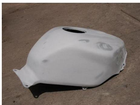
**Figura 3.9.** Cubierta de un tanque de gasolina empleado en el sector de la automoción, concretamente en una motocicleta.
