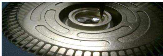
**Figura 5.4.** Imagen proceso de colocación en el calorímetro de la cápsula que contiene la muestra junto a la cápsula de referencia.
