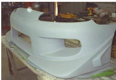
**Figura 3.8.** Componente (parachoques) del sector de la automoción reforzado con composite de fibra de vidrio como material de refuerzo.
