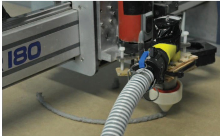
Figura 5.18 Primera versión de la boquilla mientras imprimía
