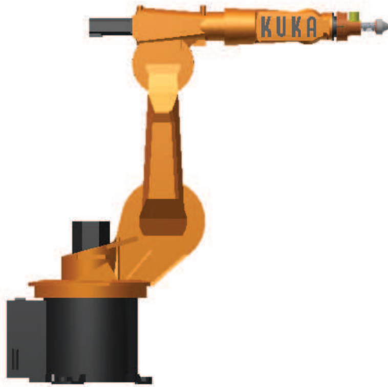
Figura 5.3 Representación del robot KUKA 15/2 con el diseño del primer cabezal en la muñeca
