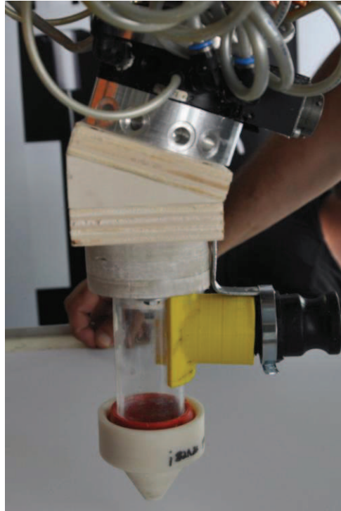
Figura 5.21 Segunda versión del cabezal de impresión montada en el robot
