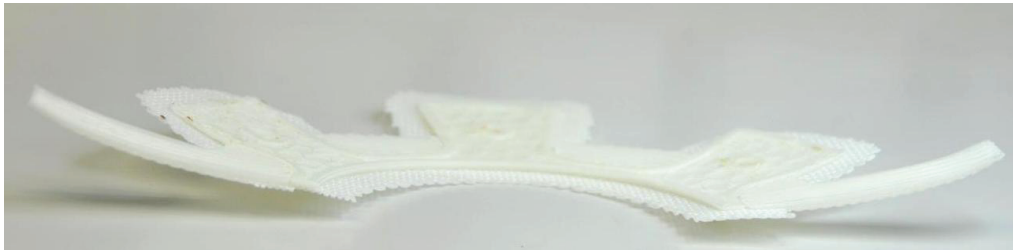
Figura 2.9 Efecto de la temperatura de la base en la impresión
