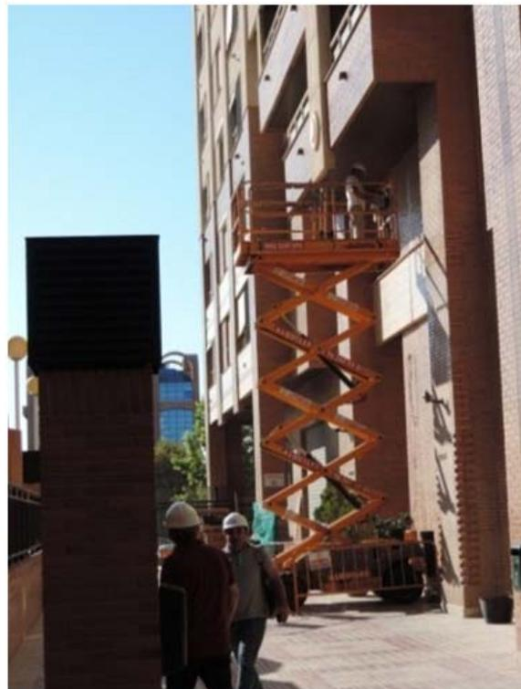
Fig. 37. Plataforma Elevadora de Tijera Móvil (Manuel Ferrer. 2014)
