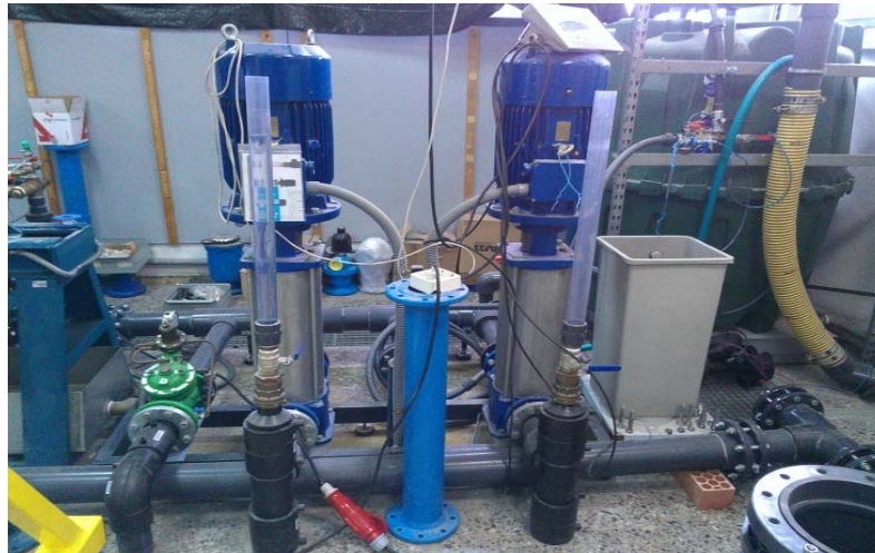
Figura 4.10. Instalación con dos bombas en paralelo.
