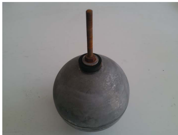
Figura 4.17. Bloqueo realizado al flotador de la ventosa modelo IRUA 930.
