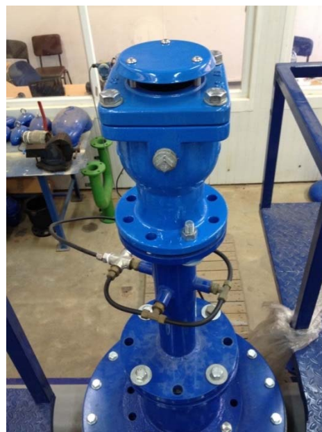
Figura 4.5. Ensayo de aire con la ventosa modelo IRUA 930.
