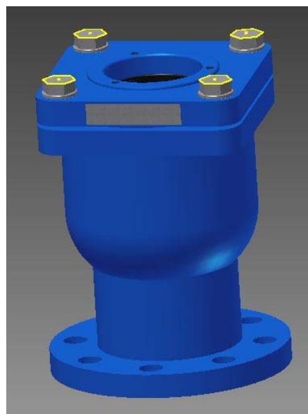
Figura 6.6. Ensamblaje parcial 3: Ventosa sin la tapa superior.
