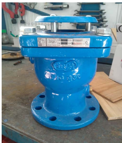
Figura 6.3. Ventosa modelo IRUA 930 de DN 80 mm (3").
