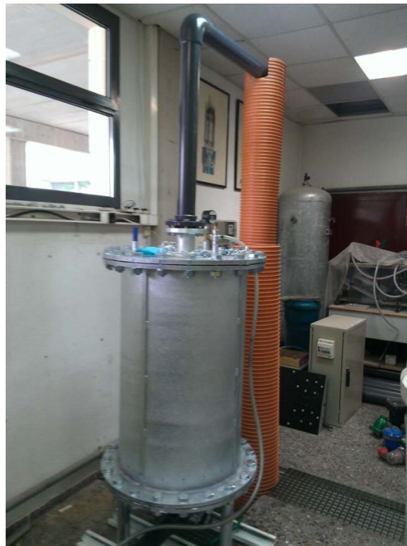
Figura 4.14. Cámara de Ensayo de Ventosas con Agua (CEVA) donde se aloja la ventosa modelo IRUA 930.
