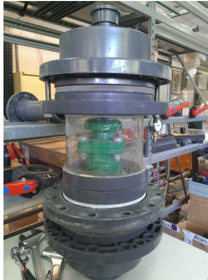
Figura 1.1. Cámara de Ensayo de Ventosas con Agua (CEVA) para una ventosa de 2”.
