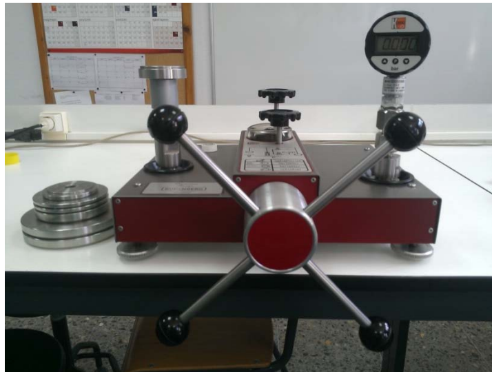
Figura 4.18. Calibrador de manómetros.
