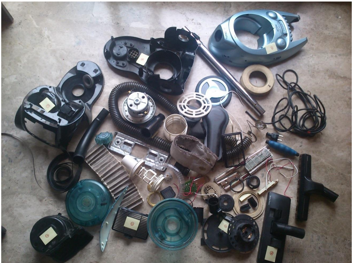
Gráfico 7 Aspiradora Solac AS-3200 Turbo AIR P desmontada. (Elaboración propia, 2014).
