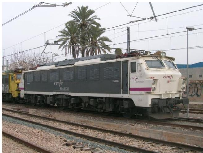
Figura 16. Locomotora serie 251 de RENFE
