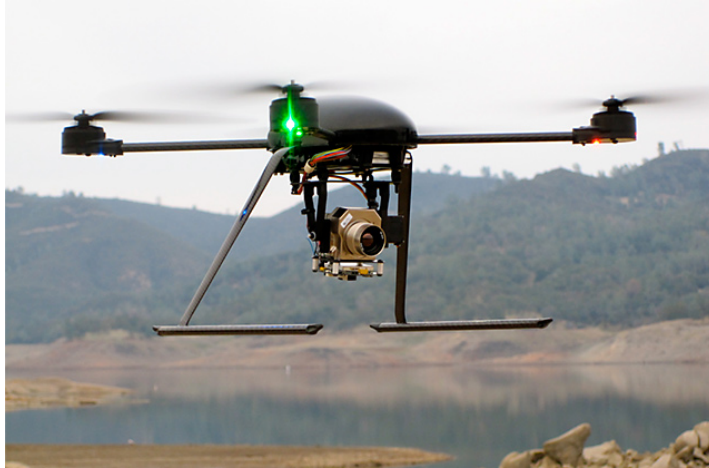
Figura 1.1: RPAS comercial de tipo Quadrotor empleado para la grabación de vídeo aéreo
