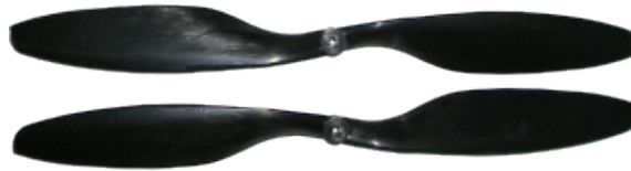
Figura 3.6: Hélices EPP1045 empleadas en el quadrotor
