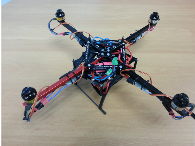
Figura 3.11: Aspecto de la estructura tras la primera fase de montaje
