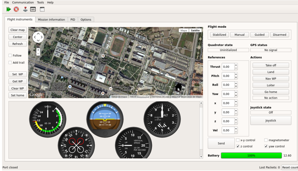
Figura 3: Interface (HMI) para la configuración del control en vuelo libre de un quadrotor.
