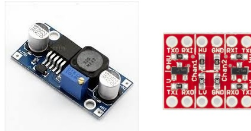
Figura 3.17: Conversor de tensión (izquierda) y conversor de niveles lógicos (derecha)
