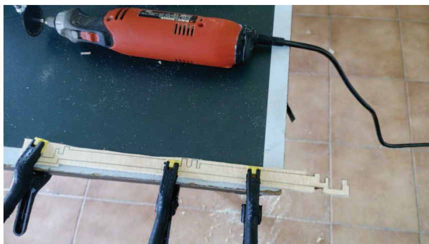
Fig 70. Recorte de las piezas complicadas con una Dremel
