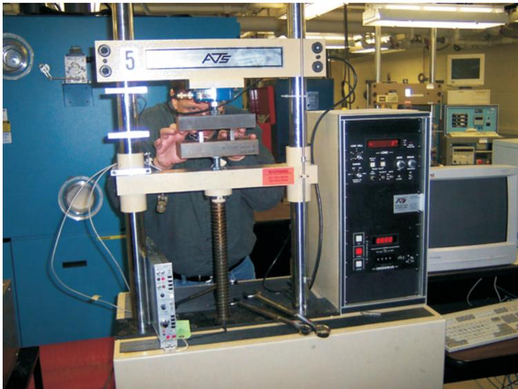
Figura 4.15: La máquina universal de ensayos ATS 910-36 utilizada para el cálculo de las constantes de proporcionalidad de cada par de galgas.
