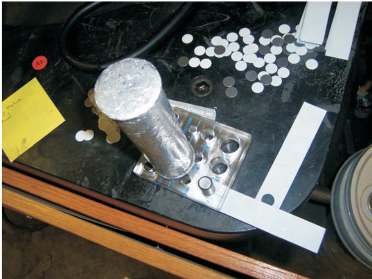
Figura 4.11: Método con el que se realizaron los agujeros a las tiras de material.
