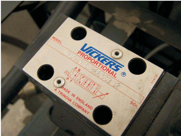
Figura 4.9: La válvula proporcional utilizada en el simulador.
