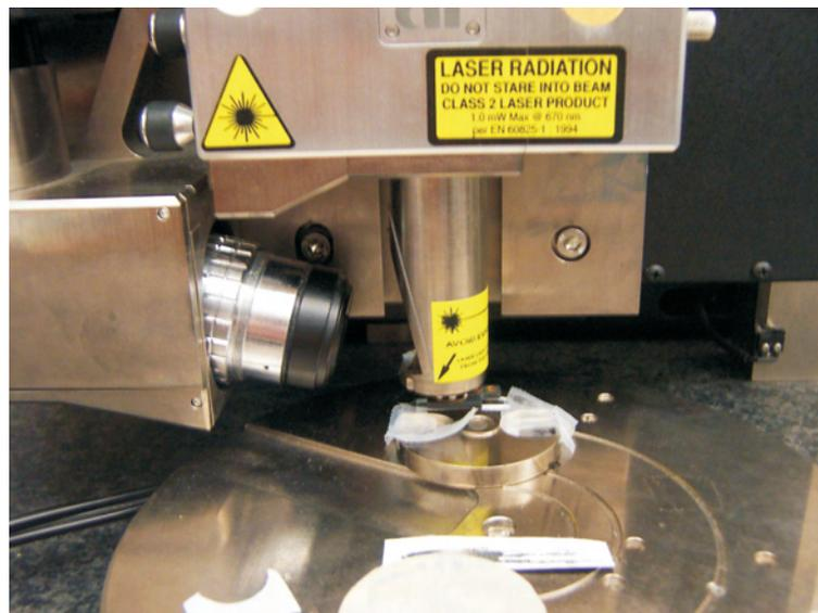
Figura 4.24: Ensayo en el microscopio de fuerza atómica.
