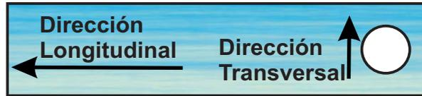
Figura 5.20: Las dos direcciones sobre las que se han tomado datos de la rugosidad superficial en las tiras de material estirado.
