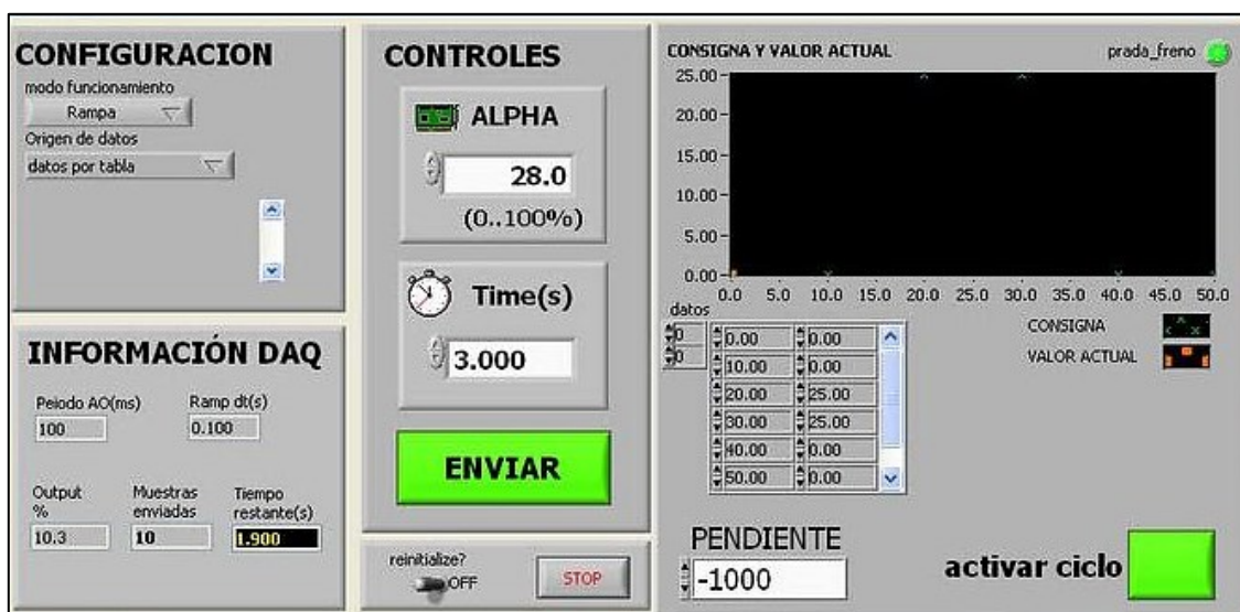
Imagen 3.40 Aplicación de control del pedal
