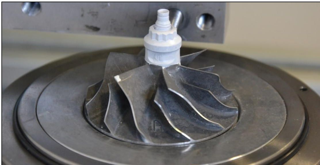
Imagen 4.5 Rueda del compresor con una muesca de equilibrado pintada de blanco
