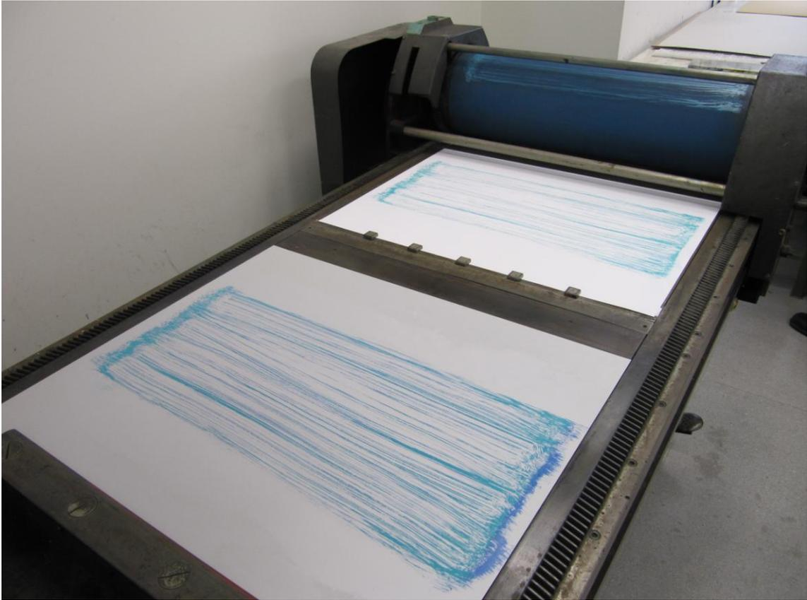
Fig. 42 Plancha de aluminio y estampa sobre prensa de *offset*.
