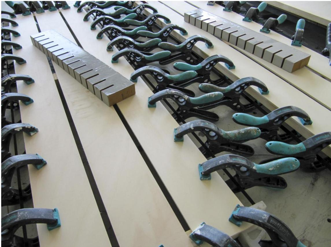
**Fig. 17** Encolado de franjas de tablero contrachapado sobre listones.
