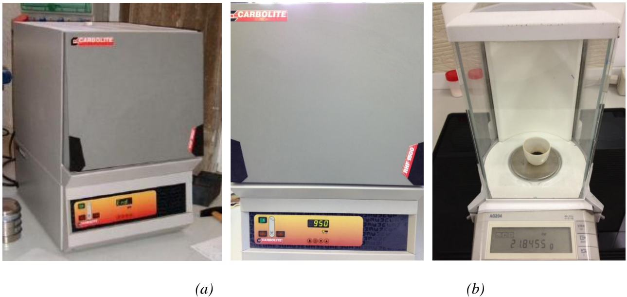
Figura 4-8 Equipo para pérdida al fuego. (a) Mufla, (b) Balanza electrónica
