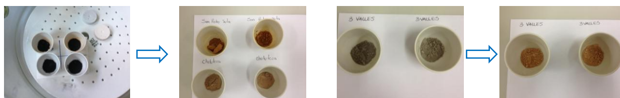
Figura 5-5 Imágenes "antes - después" de calcinación
